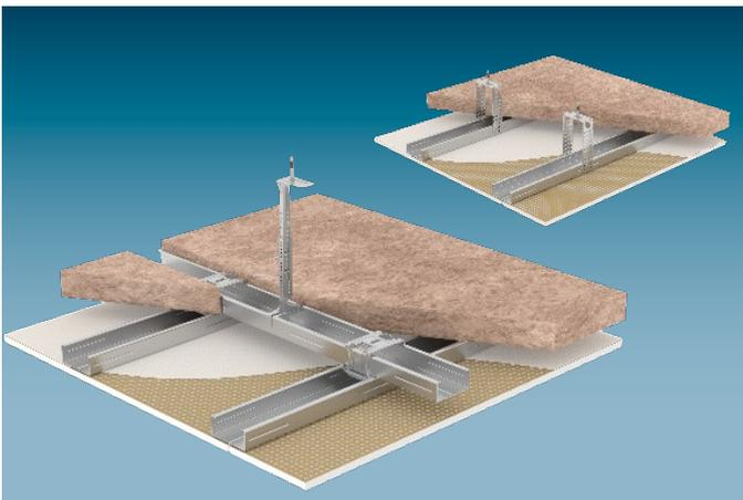
Cleaneo GO! Platten werden auf eine Metall-Unterkonstruktion aus Grund- und Tragprofilen (doppelter Profilrost) oder nur Tragprofilen (einfacher Profilrost) geschraubt. Die Befestigung der Unterkonstruktion erfolgt mit Abhängern mit geeigneten Befestigungsmitteln an die Rohdecke. Auf den Tragprofilen kann zum Zwecke der Schallabsorption eine mindestens 20 mm dicke Dämmschicht aufgelegt werden.
