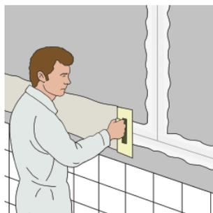
5. Zur vollflächigen Verspachtelung AQUAPANEL® Q4 Finish mit einem ca. 20 cm breiten Glätter gleichmäßig auftragen. Dabei unebene Stellen in den Fugen füllen und die Oberflächenstruktur glätten. Ggf. nach dem Trocknen schleifen. Falls die Oberflächengüte AQ4 erzielt werden muss, ist anschließend eine weitere Schicht AQUAPANEL® Q4 Finish aufzutragen.
