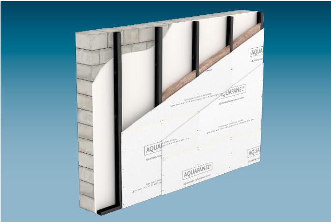
Das Vorsatzschalensystem **W686.de** wird mit einer Unterkonstruktion aus Stahlblechprofilen CW als Einfachständer freistehend vor der Grundwand ausgeführt. Die Beplankung ist zweilagig.
