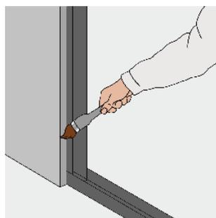
AQUAPANEL® Fugenkleber (PU) in einem durchgehenden Strang an der Kante, an der die nächste Platte angefügt werden soll, auftragen. Auf Fugenversatz entsprechend der Verlegeschemen achten
