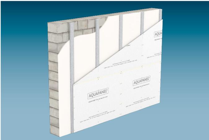
Das Vorsatzschalensystem **W684.de** wird mit einer Unterkonstruktion aus Hutprofilen, die an der Grundwand befestigt werden, ausgeführt. Somit ist eine sehr schlanke Bauweise in Verbindung mit großen Wandhöhen realisierbar. Die Beplankung ist einlagig.
