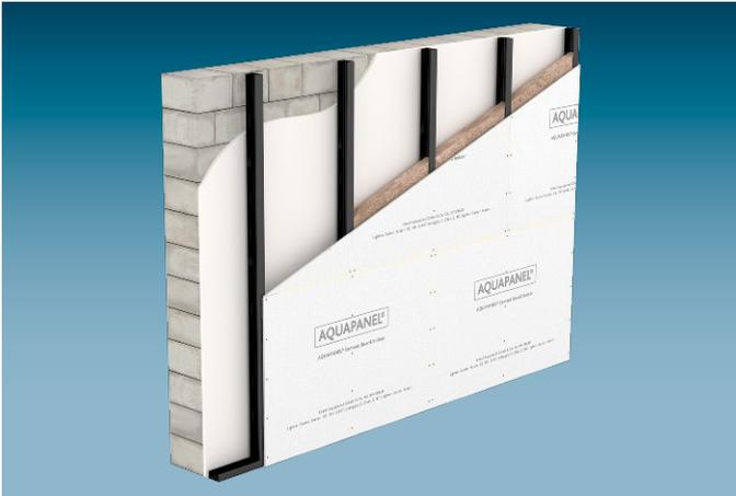
Das Vorsatzschalensystem **W685.de** wird mit einer Unterkonstruktion aus Stahlblechprofilen CW als Einfachständer freistehend vor der Grundwand ausgeführt. Die Beplankung ist einlagig.
