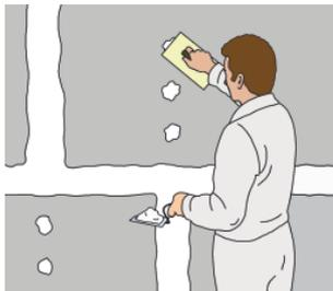
4. Alle Unebenheiten der Oberfläche abschleifen. AQUAPANEL® Q4 Finish in einer Breite von mindestens 20 cm (d. h. 5 cm über die Kanten der ersten Schicht hinaus) auftragen. Befestigungsmittel erneut einbetten und Unebenheiten entfernen.
