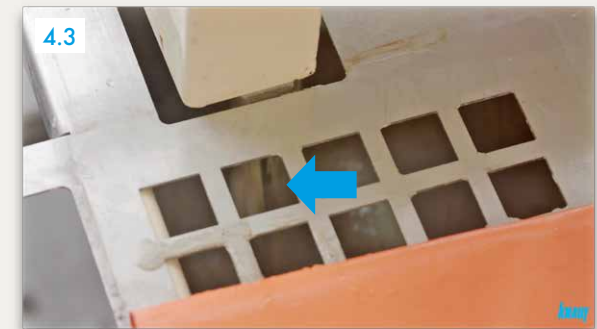
Konsistenz der Mischung optisch prüfen (Gitter) ...
