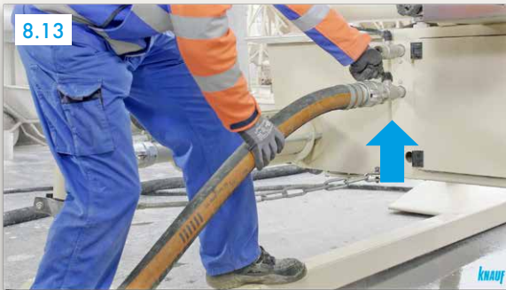
Schlauch an Reinigungsstutzen anschließen
