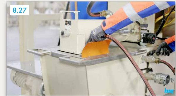
Pumpentrichter mit Wasser füllen
