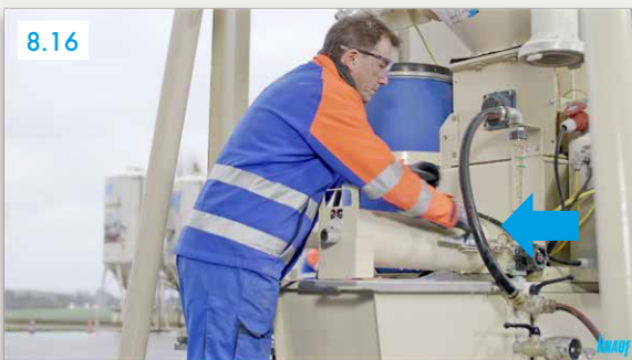
Wasserzufuhr vom Mischrohr lösen
