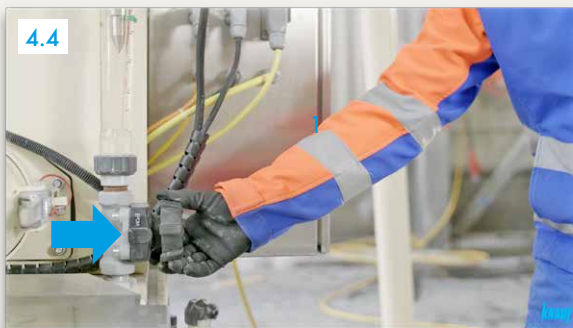
... gegebenenfalls über Wasserzufuhr grob anpassen Hinweis: Konsistenzanpassung abschließen, bevor sich die Pumpe automatisch einschaltet.
