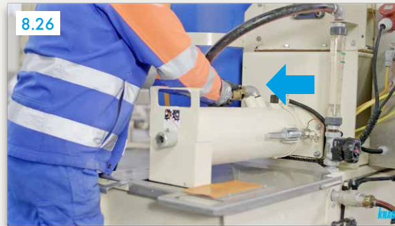
Wasserschlauch an Mischrohr wieder anschließen
