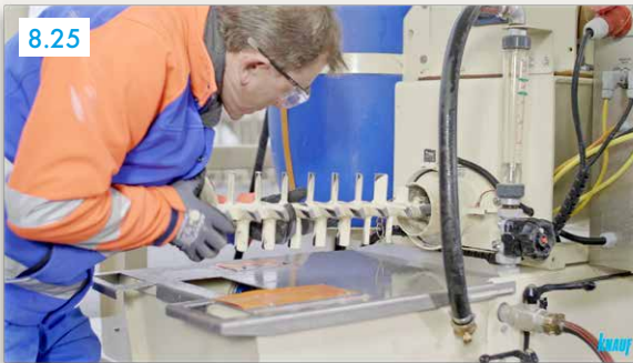
Mischrohr und Mischwelle wieder anbauen
