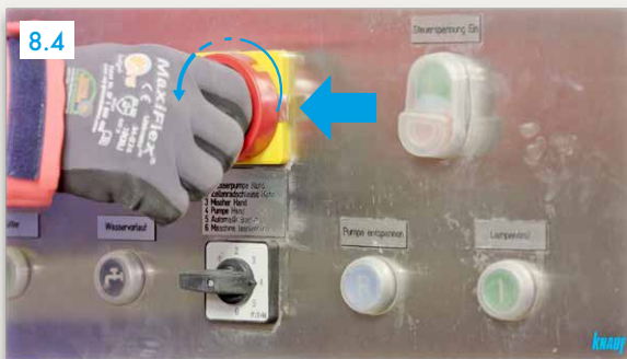
8.4 Drehrichtung an Hauptwende­schalter ändern
