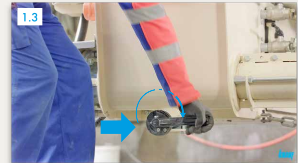
Reinigungsklappe unter Pumpentrichter schließen
