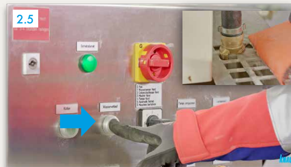
„Wasservorlauf“ drücken und testen, ob Wasser läuft
