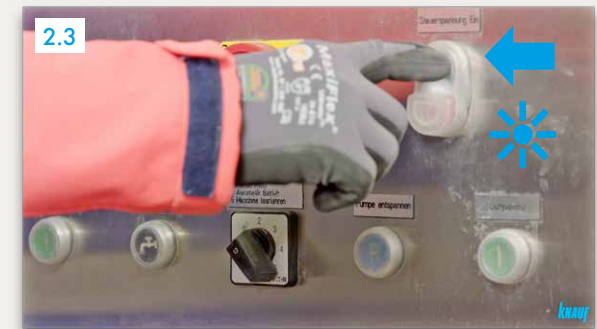
„Steuerspannung Ein“ (grüner Knopf) drücken ▶ Licht an
