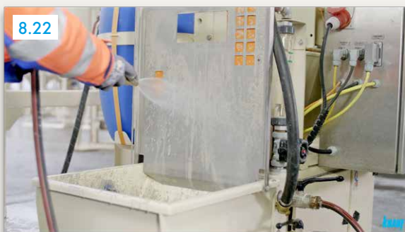
Pumpentrichter mit Wasser ausspritzen
