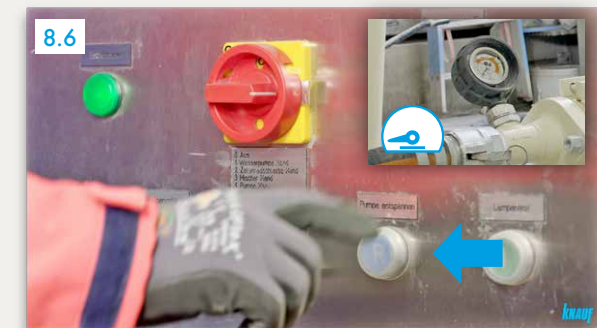
8.6 „Pumpe entspannen“ drücken Schläuche müssen drucklos sein!
