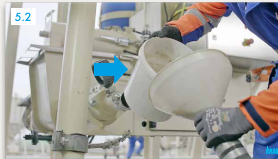
5.2 Schlämme mit Trichter in den Schlauch einfüllen
