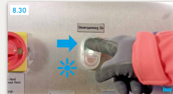
„Steuerspannung Ein“ (grüner Knopf) drücken ▶ Licht an
