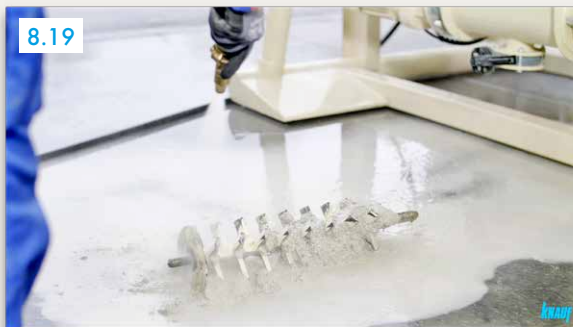
Mischwendel von Anbackungen reinigen
