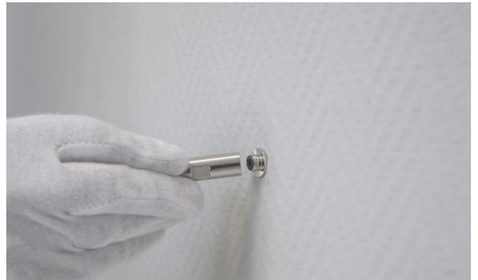
5. Schrauben Sie die Stabmagnete auf die montierten Magnetsockel auf, siehe Bild 7.
