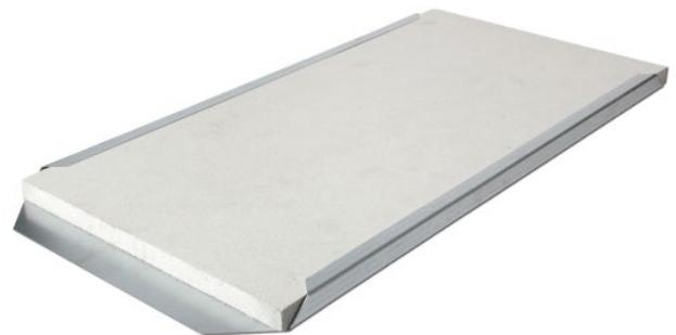
Die Befestigungstraverse mit Gipsfasereinlage ist geeignet zur Aufnahme von wandhängenden Lasten bis 1,5 kN/m Wandlänge, z. B. Schränke, Regale, Handläufe u. Ä.
