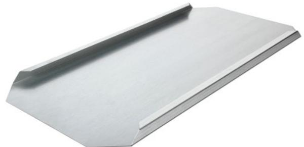
Die Befestigungstraverse ist geeignet zur Aufnahme von wandhängenden Lasten bis 1,0 kN/m Wandlänge, z. B. Handtuchhalter, Schränke, Regale u. Ä. Nicht geeignet für dynamische Lasten wie z. B. Wandklappsitze.
