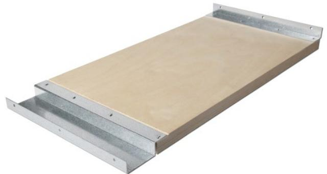
Die Universaltraverse ist geeignet zur Aufnahme von wandhängenden Lasten bis 1,5 kN/m Wandlänge, z. B. Schränke, Boiler, Wandklappsitze, Klappgriffe u. Ä.
