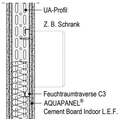
**W234.de-V17 Vertikalschnitt – Ausführung mit CW-Profil**
