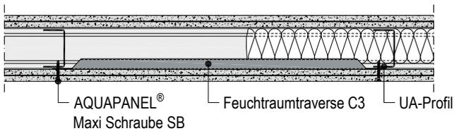
**W234.de-H17 Horizontalschnitt – Ausführung mit CW-Profil**
