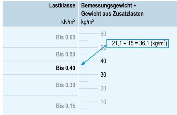
Das Eigengewicht der Decke darf 0,50 kN/m<sup>2</sup> nicht überschreiten. Die Lastklasse bis 0,65 kN/m<sup>2</sup> darf nur in Kombination mit zusätzlichen Lasten angewendet werden, z. B. „Decke unter Decke“. Bemessung nach DIN 18168-1.
