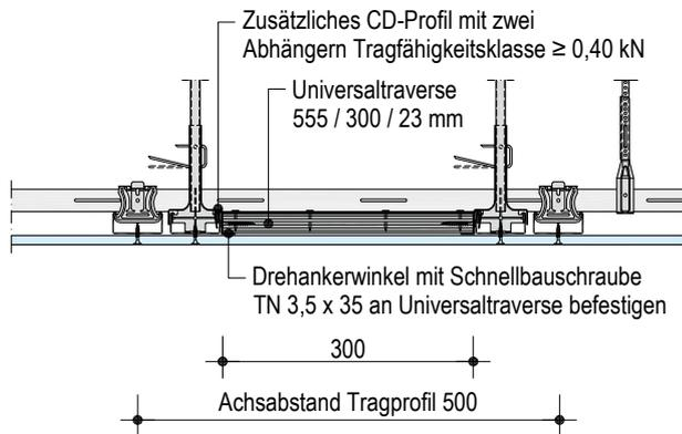
**D113.de-SO12 Vertikalschnitt – Universaltraverse**
