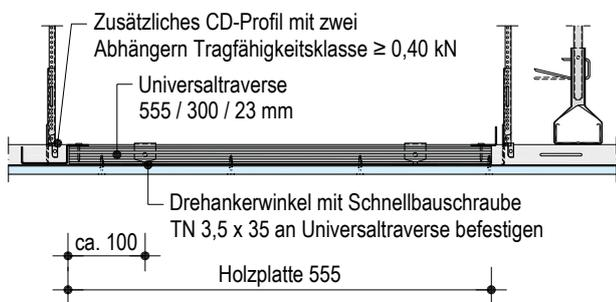
**D113.de-SO13 Vertikalschnitt – Universaltraverse**
