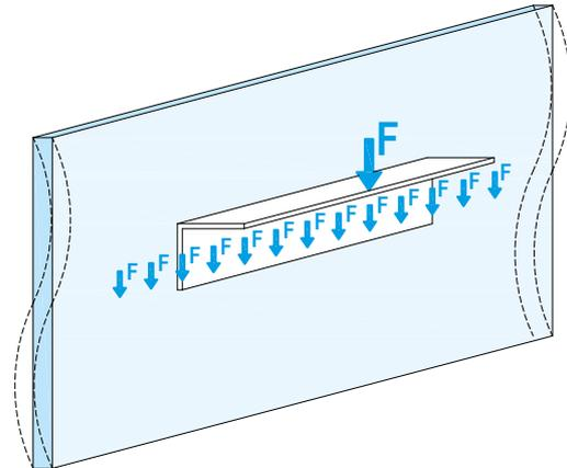
Die Konsollast wirkt als Linienlast auf das gesamte Wand-System, d. h. das Wand-System muss als Ganzes dafür ausgelegt sein, diese Last in die Tragstruktur abzuleiten ohne zu Versagen bzw. Verformungen zuzulassen, die die Grenzen der Gebrauchstauglichkeit überschreiten.
