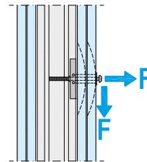
Das Anbringen von Anbauteilen (Regale, Schränke, Spiegel, Monitore) an Wandsysteme erfolgt durch Befestigungsmittel wie Schrauben und Hohlraumdübel. Die Betrachtung von Befestigungslasten erfolgt für den lokalen Wandbereich und die Tragfähigkeit des Befestigungsmittels selber.
