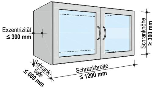
Die angegebenen zulässigen Konsollasten beziehen sich entsprechend DIN 18183 bzw. DIN 4103-1 auf eine Exzentrizität (Abstand Lastresultierende zur Wandoberfläche) von maximal 300 mm. Bei größerer Exzentrizität ist die zulässige Last entsprechend reduziert. Die folgenden Tabellen und Diagramme sind eine Hilfestellung zur Ermittlung der zulässigen Konsollasten bei abweichender Exzentrizität. Die Werte können wahlweise aus den Tabellen oder den Diagrammen abgelesen werden.
