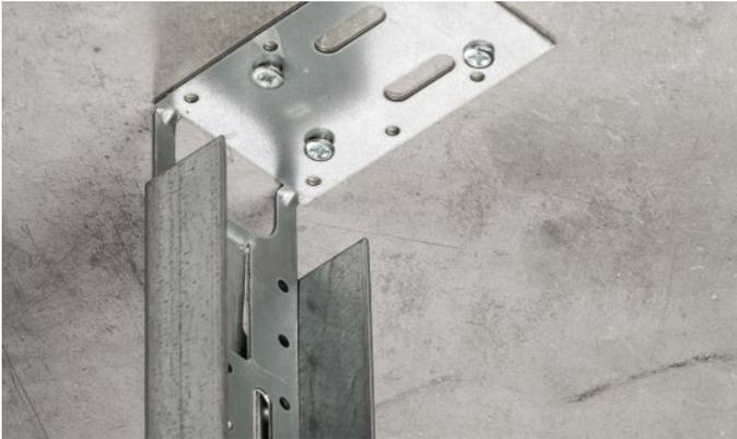
Raumhohe Tragständer aus verzinkten UA-Profilen (mind. UA 75), 2 mm dick, sind geeignet zur Weiterleitung der Lasten von Traversen in die Tragstruktur oder zur Befestigung von wandhängenden Lasten wie z. B. Schultafeln, bis 1,5 kN/m Wandlänge.
