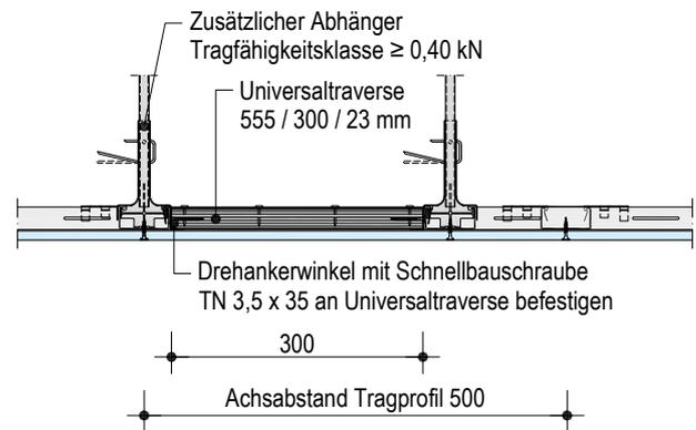
**D112.de-SO19 Vertikalschnitt – Universaltraverse**
