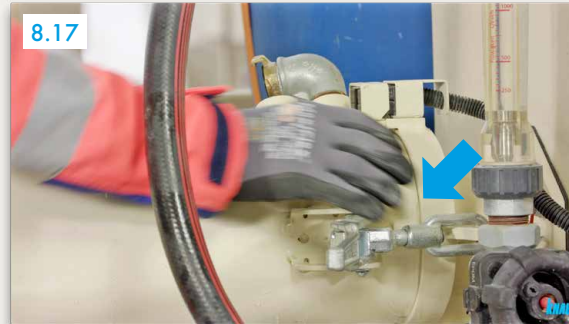
Mikser boru ve mikser milini sökün ve temizleyin
