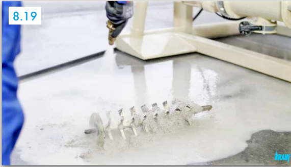
Karıştırma şaftındaki topaklanmaları temizleyin
