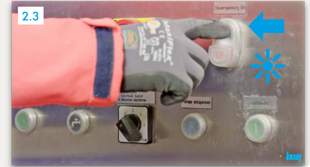
2.3 „Kontrol gerilimi açık“ (yeşil düğme) düğmesine basın ► Isık acık
