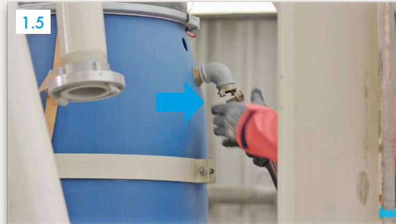
Su hortumunu varile veya su pompasına bağlayın
