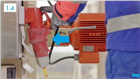
32 A yüksek akım şantiye dağıtıcısını makineye bağlayın
