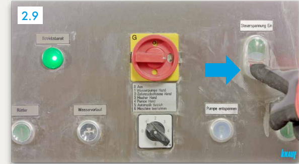
„Kontrol gerilimi açık“ (yeşil düğme) düğmesine basın ▶ Işık açık
