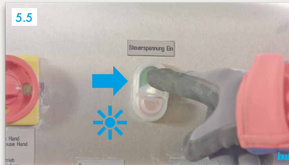
„Kontrol gerilimi açık“ (yeşil düğme) düğmesine basın ► İşık açık
