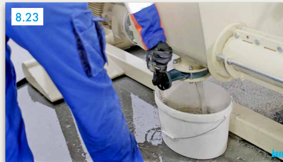
Pompa hunisinin altına bir kova koyun, pompa hunisinin altındaki temizleme klapesini açın
