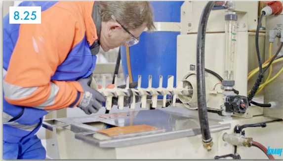
Mikser boru ve mikser milini tekrar takın
