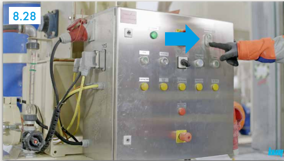
„Kontrol gerilimi açık“ (kırmızı düğme) düğmesine basın ► Isık kapalı
