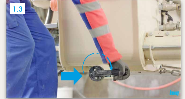
Pompa hunisinin altındaki temizleme klapesini kapatın
