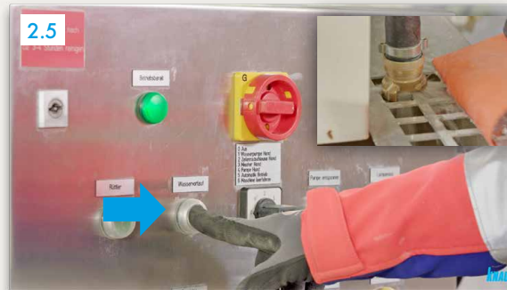
2.5 „Su gidişi“ üzerine basın ve suyun akıp akmadığını test edin
