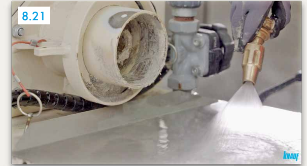
Makineyi tazyikli suyla temizleyin
