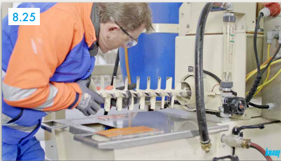
8.25 Remontarea țevii de amestec și a roturului
