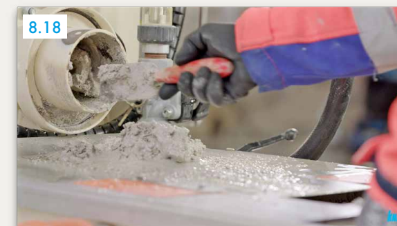
Curățarea spațiului uscat și a melcului de dozaj cu ajutorul șpaclului
