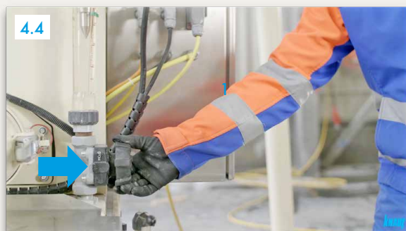
4.4 ... adaptarea în mare prin adăugarea de apă Indicație: Încheiați ajustarea consistenței înainte de pornirea automată a pompei.
