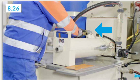
8.26 Reconectarea furtunului de apă la țeava de amestec
