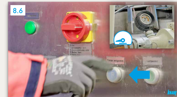
8.6 Apăsarea butonului „Pumpe entspannen” (scoaterea pompei de sub tensiune) În furtunuri nu trebuie să existe presiune!
