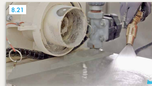
Stropirea mașinii cu apă
