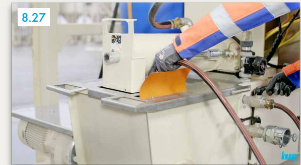
8.27 Umplerea pâlniei pompei cu apă
