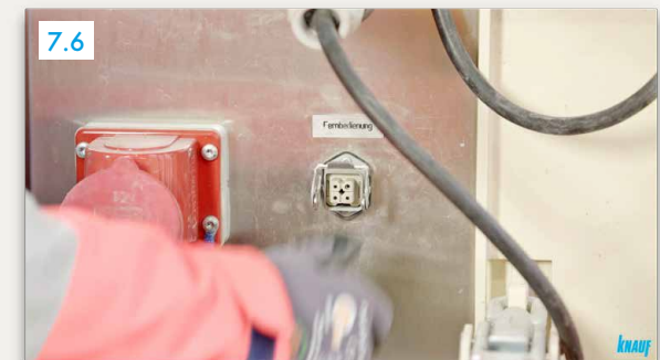
7.6 Deconectarea panoului de control (Ștecăr)
