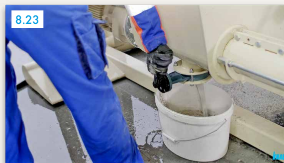
Poziționarea găleții sub pâlnia pompei, deschiderea clapetei de curățare sub pâlnia pompei
