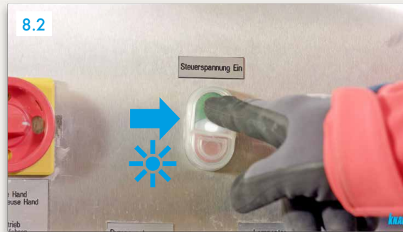
8.2 Apăsarea butonului verde Steuerspannung Ein (Tensiune de control pornită) ► Lumină pornită Rularea mașinii până când apa din pompa melc este curată t
