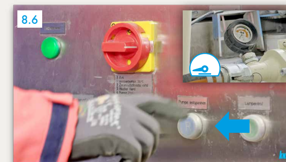
8.6 Pritisnuti „Rasterećenje crpke“ Crijeva ne smiju biti pod tlakom!
