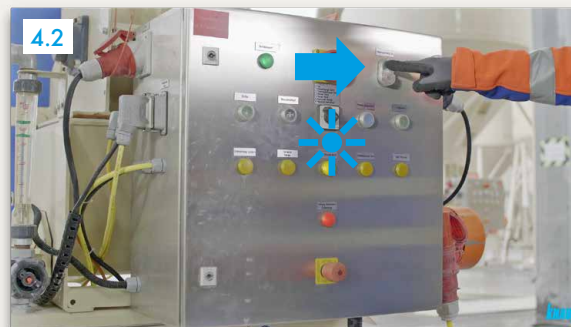
4.2 Pritisnuti „Upravljački napon uključen“ (zeleni gumb) ► svjetlo uključeno
