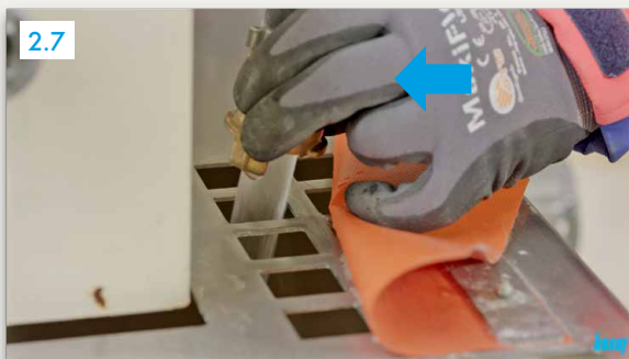
2.7 Lijevak crpke puniti vodom (cca. 10 sekundi)
