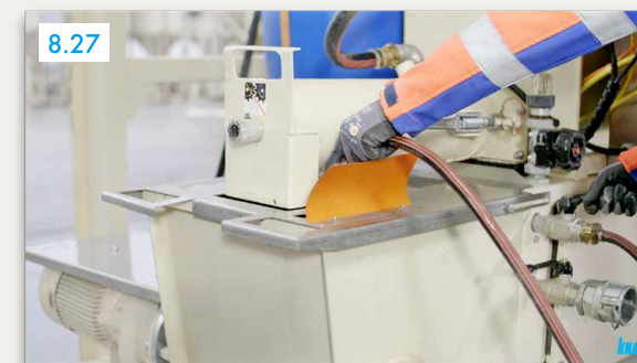
Lijevak crpke napuniti vodom
