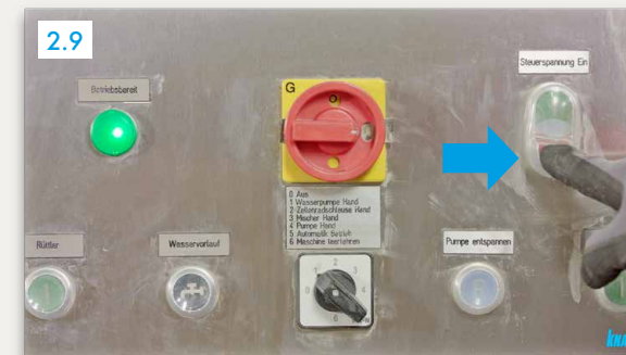
2.9 Pritisnuti „Upravljački napon uključen“ (zeleni gumb) ► svjetlo uključeno
