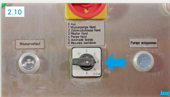
2.10 Okretnu sklopku postaviti na „4-crpkica za vodu ručno,“
