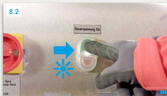
8.2 Pritisnuti „Upravljački napon uključen“ (zeleni gumb) ► svjetlo uključeno Pustiti stroj da radi dok ne počne istjecati čista voda kroz pužnu crpku
