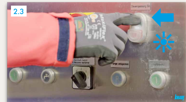
2.3 Pritisnuti „Upravljački napon uključen“ (zeleni gumb) ► svjetlo uključeno
