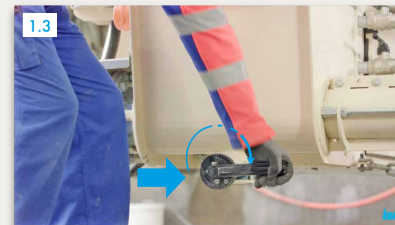
1.3 Zatvoriti zaklopku za čišćenje ispod lijevka crpke
