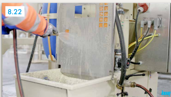
Lijevak crpke ištrcati vodom
