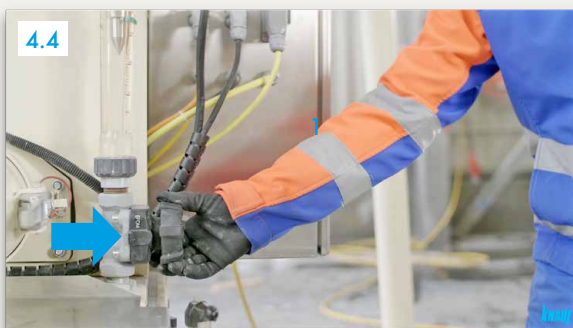
4.4 ... ukoliko je potrebno podesiti preko dovoda vode Napomena: podešavanje konzistentnosti završiti prije no što se crpka automatski uključi.
