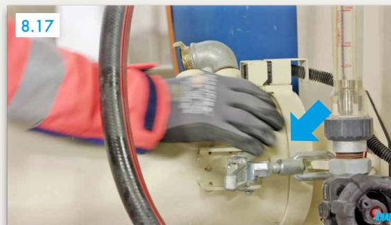
**Mischrohr und Mischwelle ausbauen und reinigen**
