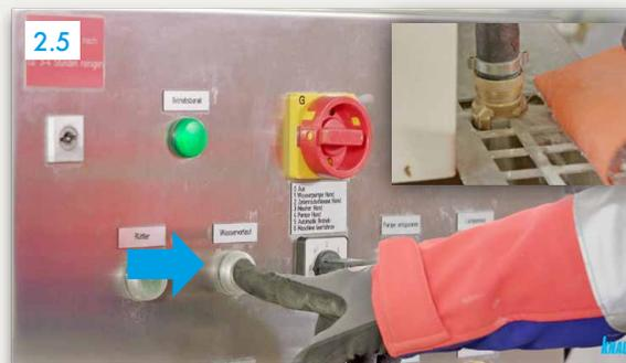
**„Wasservorlauf“ drücken und testen, ob Wasser läuft**
