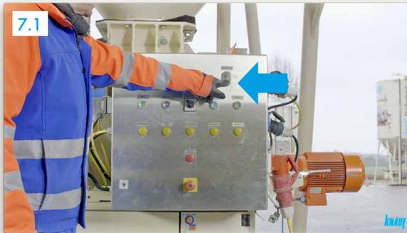
7.1 „Steuerspannung Ein“ (roter Knopf) drücken ▶ Licht aus
