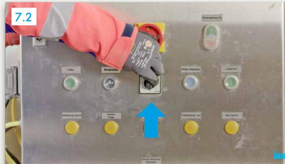
7.2 Drehschalter auf „6-Maschine leerfahren“ stellen
