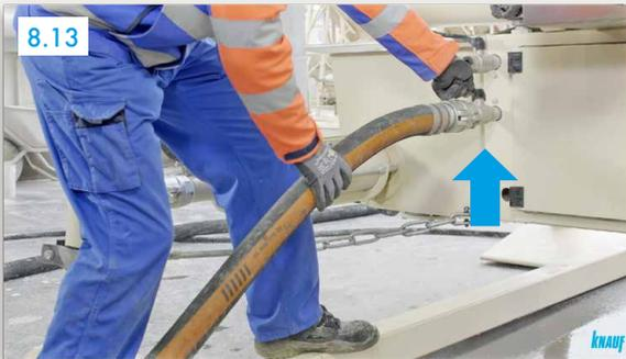
**Schlauch an Reinigungsstutzen anschließen**
