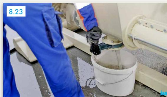
**Eimer unter Pumpentrichter stellen, Reinigungsklappe unter Pumpentrichter öffnen**
