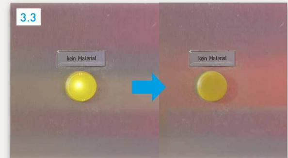
**Material einfüllen ▶ „kein Material“-Leuchte ▶ Licht aus**
