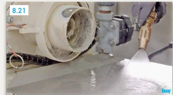
**Maschine mit Wasser abspritzen**
