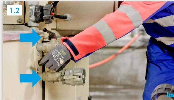
**Ventile an Wasserausgängen schließen**
