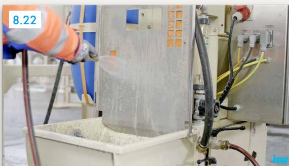
**Pumpentrichter mit Wasser ausspritzen**
