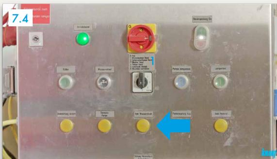
7.4 Maschine über Fernbedienung anschalten (Knopf raus), „kein Wasserdruck“-Leuchte ▶ Licht aus
