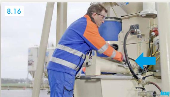
**Wasserzufuhr vom Mischrohr lösen**
