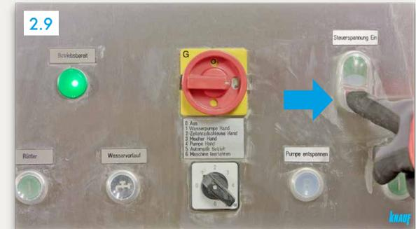
**„Steuerspannung Ein“ (roter Knopf) drücken ▶ Licht aus**
