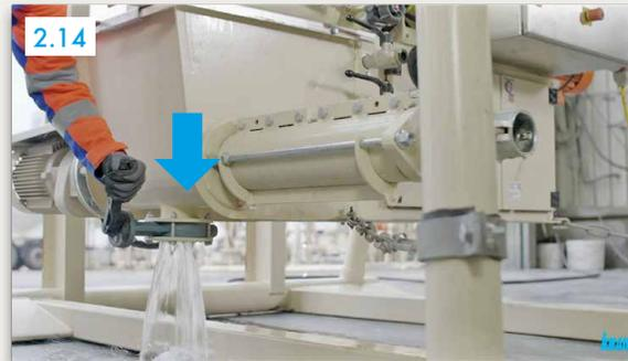
Reinigungsklappe unter Pumpenrichter öffnen und Wasser abfließen lassen
