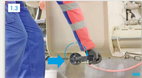
**Reinigungsklappe unter Pumpentrichter schließen**
