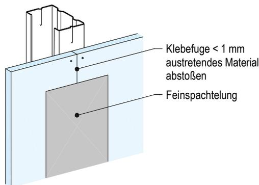
2. Die nächste Platte mit Druck anfügen (Fugenbreite < 1 mm) und sofort verschrauben.
