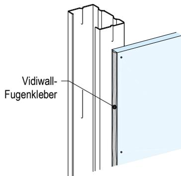
1. Platten mittig am Profil montieren. Anschließend Fugenkleber auf die Kante der montierten Platte gleichmäßig raupenförmig auftragen.
