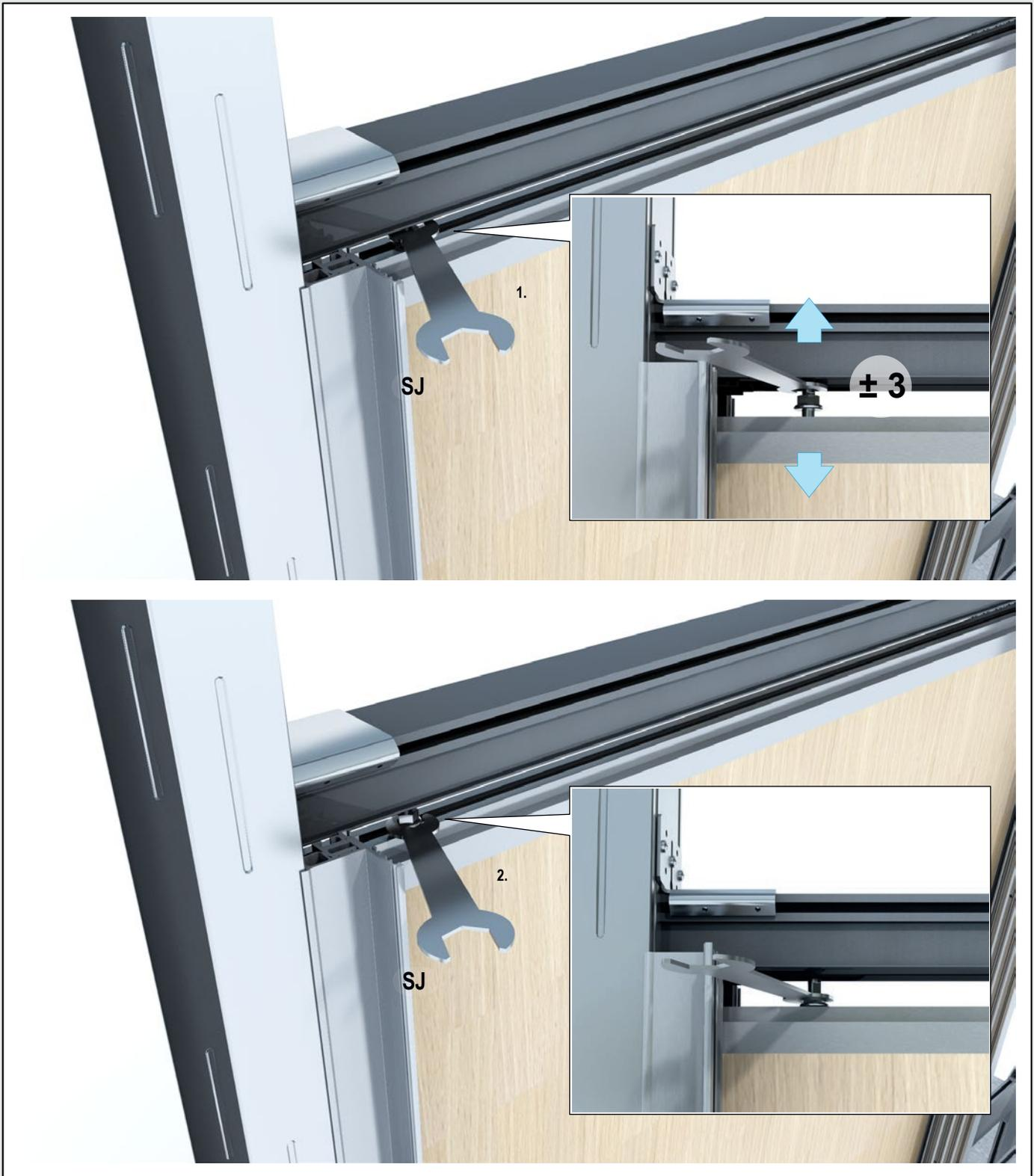
25 Bodenführung montieren
