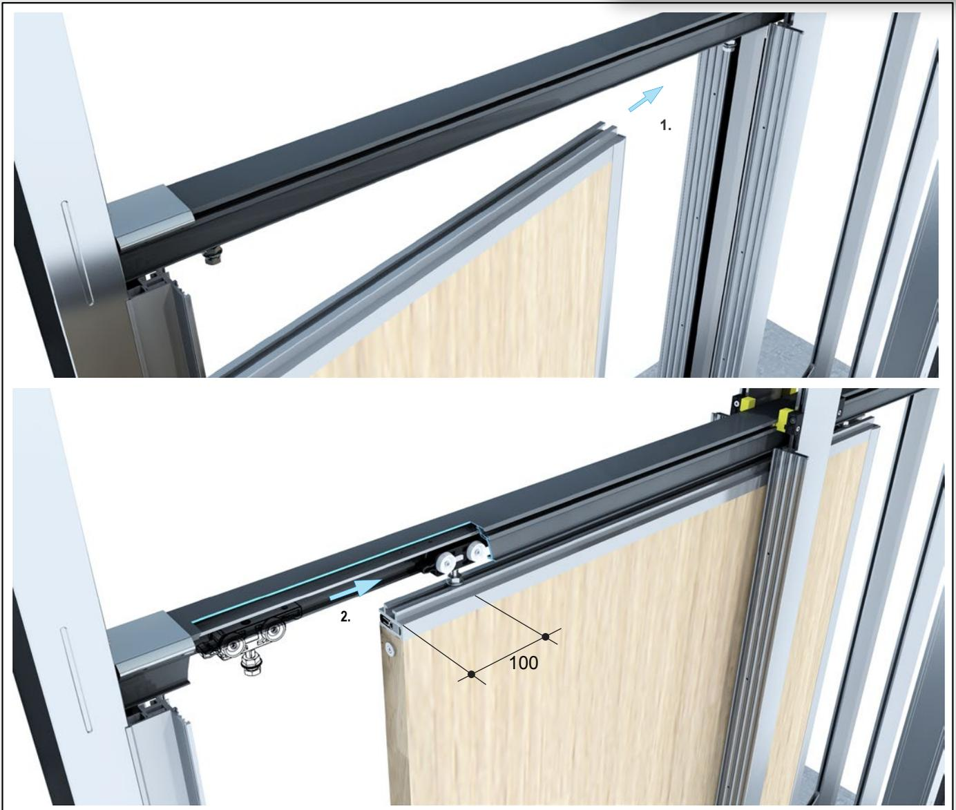
24 Tür auf der Anschlagseite am CW-Profil ausrichten und festschrauben
