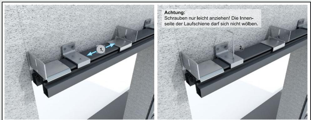
7 CW-Profil einsetzen und an Laufschiene schrauben
