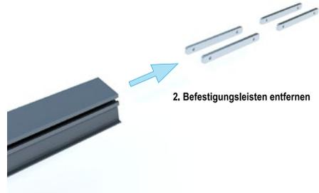
2. Befestigungsleisten entfernen
