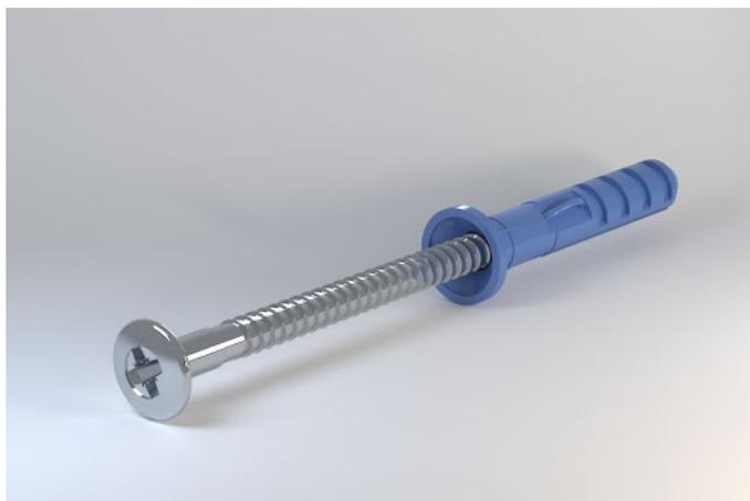
Der Knauf Drehstiftdübel ist ein hochwertiger Kunststoff-Nageldübel mit verzinkter Qualitätsschraube zur Randverankerung von Trockenbau-Systemen. Die zulässige Belastung bei Scherbeanspruchung beträgt 0,5 kN.
