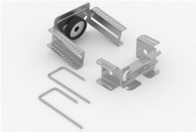
**Justierbarer Direktschwingabhänger für CD 60/27 zur akustisch entkoppelten, nachträglich justierbaren Befestigung der Unterkonstruktion abgehängter Decken**
