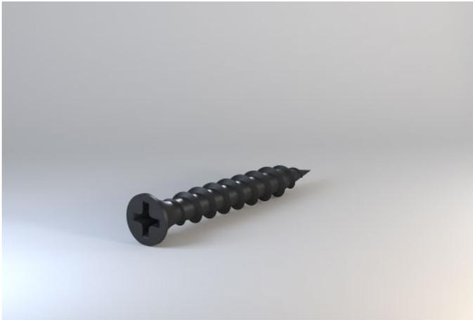
Gipsschraube mit selbstschneidendem Grobgewinde und Nagelspitze aus unlegiertem Stahl, korrosionsschutz durch Phosphatierung. Die spezielle Geometrie gewährleistet optimalen Halt bei der Befestigung von Gipsplatten an Gipsplatten.
