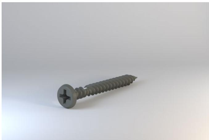
Korrosionsschutzte Schnellbauschraube mit Nagelspitze und selbstschneidendem Spezialgewinde aus unlegiertem Stahl für die Verschraubung von Drystar-Board auf Metall-Unterkonstruktion mit der Klassifizierung C3-C5M. Die spezielle Geometrie des Gewindes sorgt für ein leichtes Einschrauben und Anziehen der Schraube in Drystar-Board.
