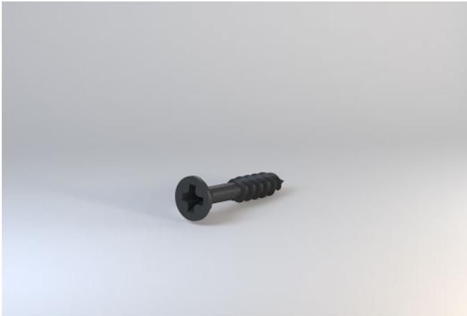
Spezial-Gipsfaserschraube mit Halbkugel-Schälkopf und gewindefreiem Teil unterhalb des Kopfes für Brio-Elemente, phosphatiert.
