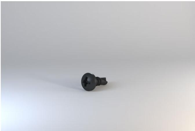
Blechschauben LB (Bohrspitze) mit selbstschneidendem Feingewinde aus unlegiertem Stahl, korrosionsschutz durch Phosphatierung.
