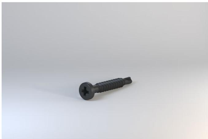
Korrosionsgeschützte Schnellbauschraube mit Spezialbohrspitze und selbst-schneidendem Gewinde aus unlegiertem Stahl für die Verschraubung aller Thermoboard-Varianten. Ihr Spezialbohrgewinde sowie der passende Flachkopf sorgen für ein optimales Lochbild und eine perfekte Oberflächenoptik. Korrosionsgeschützt durch Phosphatierung.
