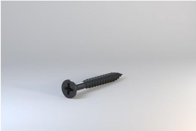
Schnellbauschraube mit selbstschneidendem Blechschraubengewinde und Nagelspitze aus unlegiertem Stahl für die Verschraubung von Knauf Cleaneo Akustik Platten auf Unterkonstruktionen aus Stahlblech, korrosionsschutz durch Phosphatierung.
