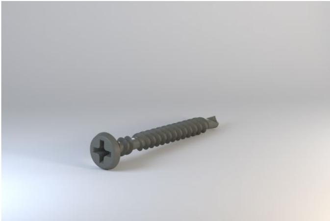
Korrosionsschutzgeschützte Schnellbauschraube mit Bohrspitze und selbstschneidendem Spezialgewinde aus unlegiertem Stahl für die Verschraubung von Drystar-Board in Feucht- und Nassräumen. Die spezielle Geometrie des Gewindes sorgt für ein leichtes Einschrauben und Anziehen der Schraube in Drystar-Board.
