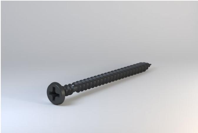
Schnellbauschraube mit Nagelspitze und selbstschneidendem Spezialgewinde aus unlegiertem Stahl für Hartgipsplatten, korrosionsschutz durch Phosphatierung. Die spezielle Geometrie des Gewindes sorgt für ein leichtes Einschrauben und Anziehen der Schraube in Hartgipsplatten.
