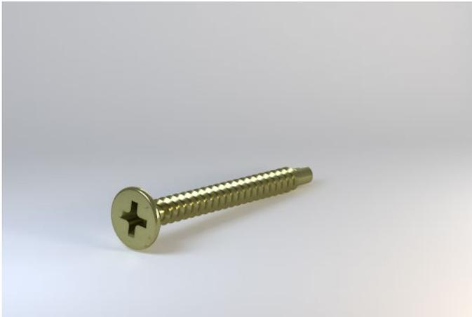
AQUAPANEL® Maxi Schraube SB wurde speziell für die Befestigung der AQUAPANEL® Cement Board auf Metallunterkonstruktion entwickelt. Sie kann für Wände im Innen- wie Außenbereich verwendet werden. Für die Verschraubung von AQUAPANEL Cement Board auf Unterkonstruktion mit der Klassifizierung C3-C5M.
