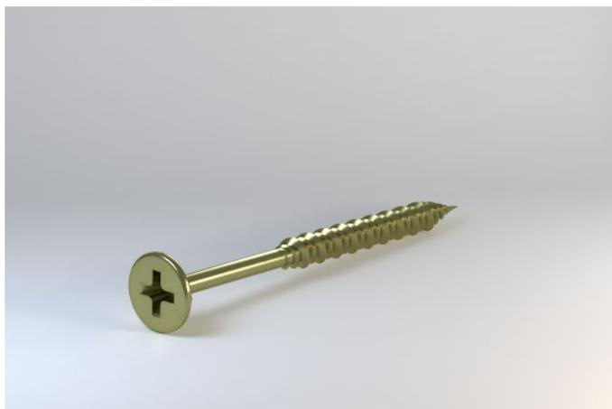
AQUAPANEL® Maxi Schraube SN mit Nagelspitze wurde speziell für die Befestigung von AQUAPANEL® Cement Board auf Holz- und Metallunterkonstruktionen entwickelt. Sie kann für Wand und Decke im Innen- wie Außenbereich verwendet werden. Für die Verschraubung von AQUAPANEL Cement Board auf Unterkonstruktion mit der Klassifizierung C3-C5M.
