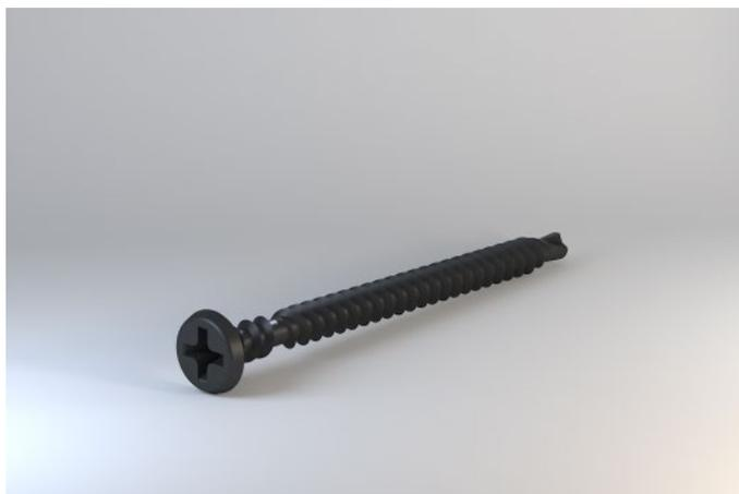
Schnellbauschraube mit Bohrspitze und selbstschneidendem Spezialgewinde aus unlegiertem Stahl mit spezieller Geometrie für das Einschrauben in Hartgipsplatten, korrosionsschutz durch Phosphatierung. Die spezielle Geometrie des Gewindes sorgt für ein leichtes Einschrauben und Anziehen der Schraube in Hartgipsplatten.
