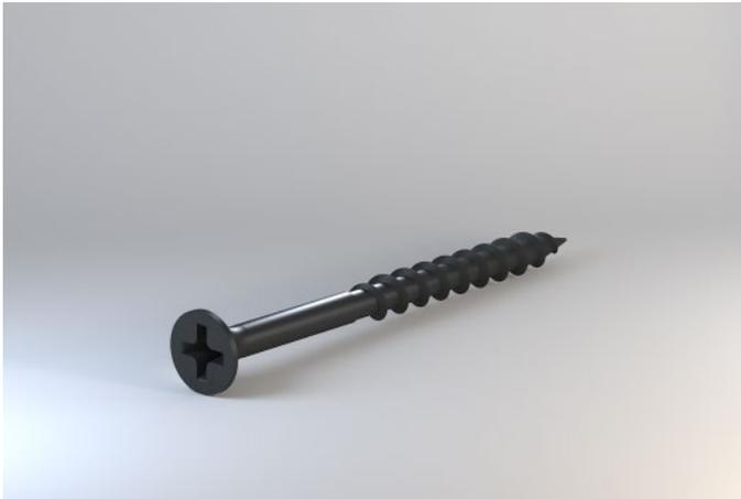
Schnellbauschraube mit Nagelspitze und Grobgewinde aus unlegiertem Stahl, korrosionsschutz durch Phosphatierung für Holz. Das Grobgewinde gewährleistet optimalen Halt in Holz.
