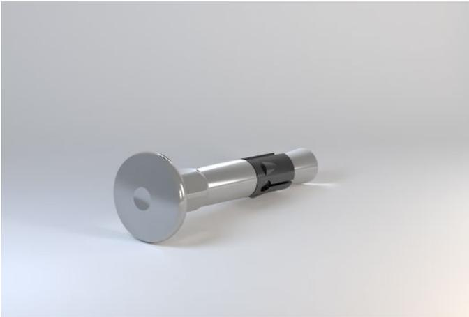
Der Deckennagel ist ein Dübel aus galvanisch verzinktem Stahl, bestehend aus Konusbolzen und Spreizclip. Der Deckennagel ist zur Verwendung im Beton für redundante nicht tragende Systeme. Die erforderliche Betongüte bewegt sich zwischen Normalbeton (bewehrt oder unbewehrt) der Festigkeitsklasse C12/15 und C50/60 nach DIN EN 206-1 bzw. DIN 1045-2. Er kann zudem unter ruhender und quasi-ruhender Belastung im gerissenen oder ungerissenen Beton eingesetzt werden.
