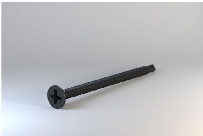
Schnellbauschraube mit Bohrspitze und selbstschneidendem Blechschraubengewinde aus unlegiertem Stahl, korrosionsschutz durch Phosphatierung. Die Kombination aus Bohrspitze und passendem Gewinde gewährleistet optimales Eindringen und festen Halt in größeren Profilstärken.
