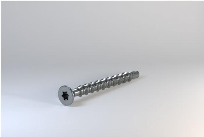
AQUAPANEL® Fassadenschraube SB 40 mit Bohrspitze wurde speziell für die Befestigung der AQUAPANEL® Cement Board auf Aluminiumunterkonstruktionen 2 mm entwickelt.
