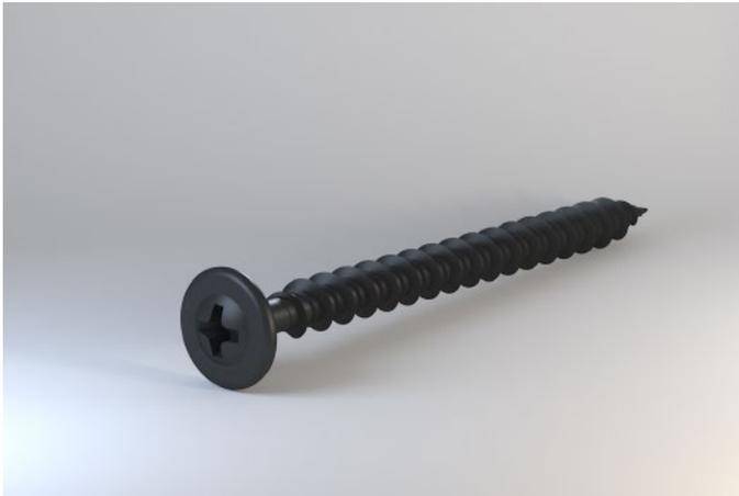
Schnellbauschraube mit doppelgängigem Gewinde und Nagelspitze aus unlegiertem Stahl, korrosionsschutz durch Phosphatierung. Das Spezialgewinde gewährleistet optimalen Halt sowohl in Blech als auch in Holz.
