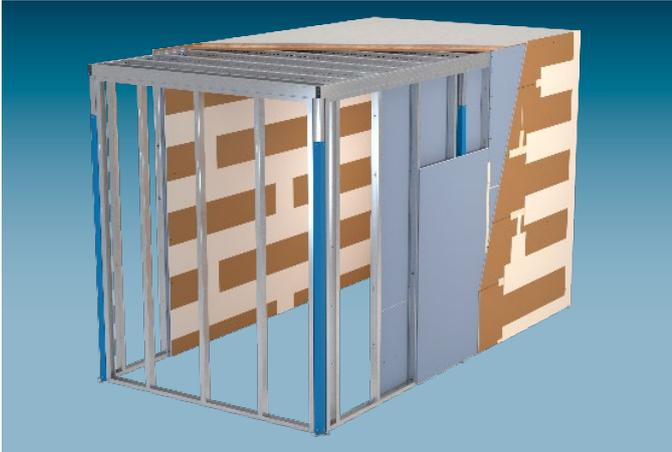
Der Cubo Empore ist die Lösung für raumbildende Maßnahmen, bei denen auch die Deckenfläche genutzt werden darf. Von ruhenden Auflasten über bedingte Begehbarkeit zu Wartungszwecken bis hin zur Funktion als Nutzfläche kann der Cubo Empore hergestellt werden. Zur Querverteilung der planmäßigen Auflasten dient eine Holzwerkstoffplatte mit einer Dicke  $\geq 22$  mm, bei Brand- oder Schallschutzanforderungen mit weiteren Beplankungslagen.
