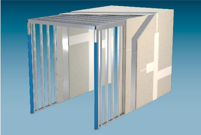
Der Cubo Fluchttunnel bietet als selbsttragendes Raum-in-Raum System eine Feuerwiderstandsdauer von 90 Minuten sowie eine allseitige Widerstandsfähigkeit gegen Stoßbeanspruchung von 3000 Nm. Diese Widerstandsfähigkeit wird durch eine Lage Stahlblech (t = 0,5 mm) zwischen den Beplankungslagen der Wände sowie unterhalb oder zwischen den Beplankungslagen der Deckenoberseite erreicht.
