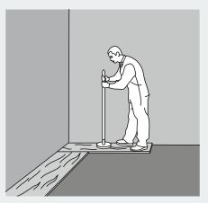
2. Schaltafeln oder OSB-Platten auf Abdeckplatten legen und vom Rand beginnend schneckenförmig nach innen mit Handstampfer verdichten
