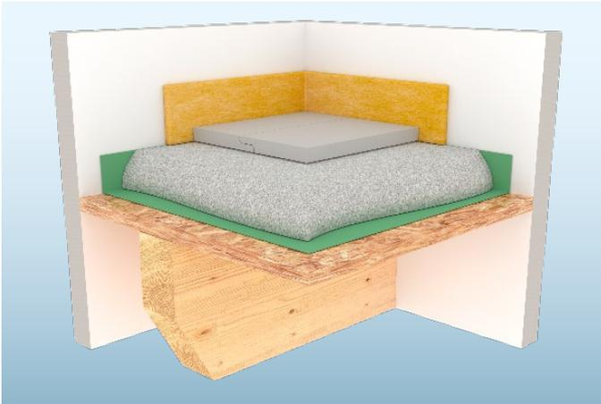
Fertigteilestrich wird getrennt vom Untergrund auf Schrenzlage oder tragfähiger Ausgleichsschicht eingebracht, um Unebenheiten unter dem Fertigteilestrich auszugleichen.
