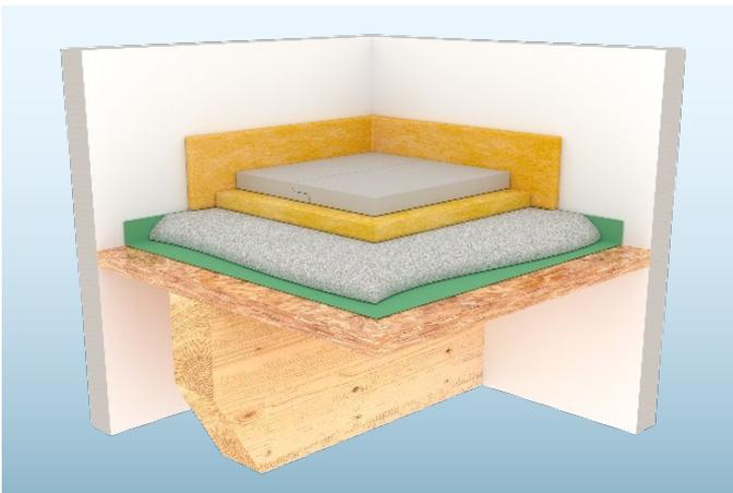
Fertigteilestrich auf separater Dämmschicht, als Verbundelement (Knauf Brio WF/EPS/MW) oder auf Leichtausgleichmörtel, um Brandschutz, Schallschutz, Wärmeschutz oder einen Höhenausgleich zu erreichen.
