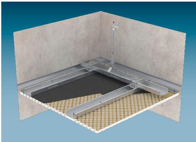
Cleaneo UFF Putzträgerplatten mit rückseitiger Vlies- oder Folienkaschierung werden auf eine Metall-Unterkonstruktion aus Grund- und Tragprofilen (doppelter Profilrost) aus Stahlblechprofilen CD 60/27 geschraubt. Die Befestigung der CD-Profile erfolgt mit Abhängern an der Rohdecke.
