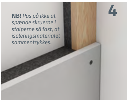
Første stolpe placeres tæt til den tilstødende væg og fastskrues. Elementets isoleringsmateriale tilskæres.
