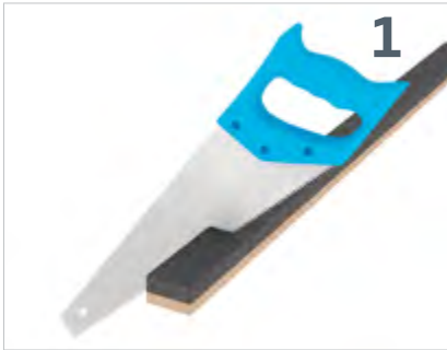
1. Isoleringsstolpen tilskæres med en fintandet sav.
