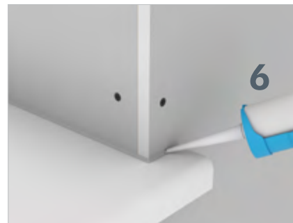
Efter montagen tættes med acrylfugemasse mellem elementet og de tilstødende flader.
