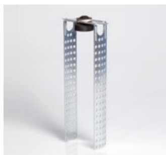
Άμεση αντικραδασμική ανάρτηση Π για CD 60/27. Για ηχομονωτικά βελτιωμένη άμεση στερέωση, μήκος βραχίονα 50/120/200 mm.
