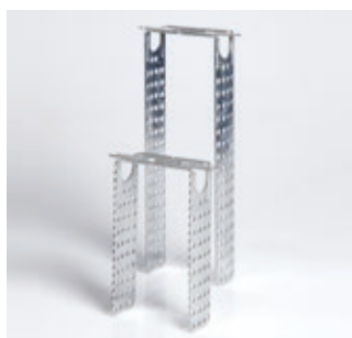
Άμεση ανάρτηση Π για CD 60/27. Για άμεση στερέωση με μήκος βραχίονα 50/120/200 mm. Οι βραχίονες 120 mm διατίθενται επίσης με αντιδιαβρωτική προστασία C3.
