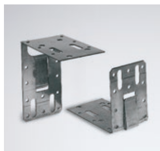
Χωνευτή γωνία για λαμπάδες θυρών Εφαρμόζεται σε λαμπάδες θυρών με προφίλ CW ή UA 50/75/100 mm για ολισθαίνουσα σύνδεση με τη φέρουσα οροφή και το δάπεδο.
