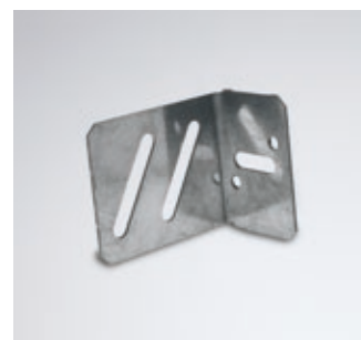
Γωνία σύνδεσης Για στερέωση ενισχυμένων προφίλ UA 50/75/100 mm σε συστήματα τοίχων. Διατίθεται με αντιδιαβρωτική προστασία C3 και C5M.
