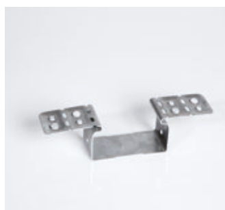
Σπαστή ανάρτηση κλειστού τύπου Ω για CD 60/27. Για άμεση στερέωση σε ξύλινες δοκούς. Δυνατότητα ρύθμισης ύψους 20 mm.
