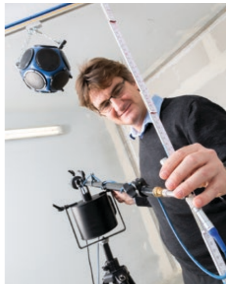
Τοποθέτηση εξοπλισμού μετρήσεων ηχομόνωσης σε διάταξη ελέγχου τοιχοποιίας.
