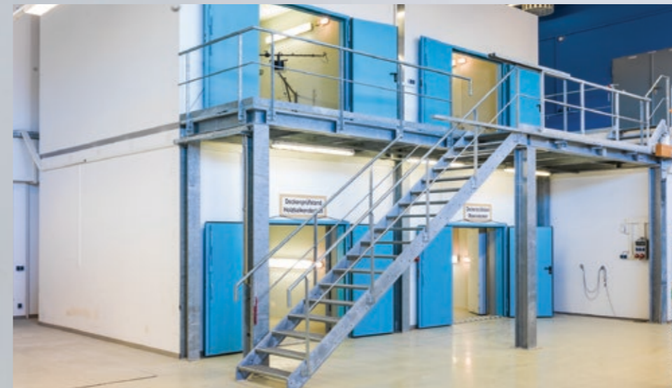
Εξωτερική όψη του θαλάμου ελέγχου ηχομόνωσης.
