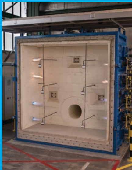
Δοκιμή πυραντοχής σε διάταξη για τοιχοποιία διαστάσεων 3 x 3 m.
