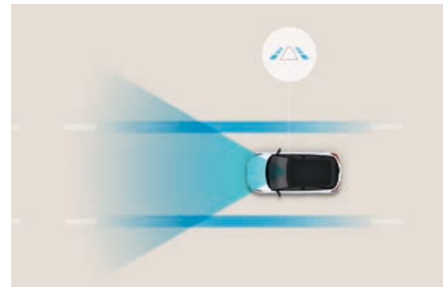
Asistente de seguimiento de carril (LFA). Cuando se activa, este sistema mantiene el vehículo centrado en su carril a velocidades de entre 0 y 180 km/h en ciudad y carretera.
