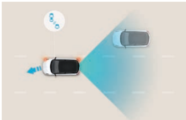
Sistema de detección de ángulo muerto (BCA). Mediante dos sensores situados en la parte inferior del parachoques trasero, el sistema te avisa de los vehículos que se acercan por la zona del ángulo muerto. Si activas el intermitente en esa dirección, el sistema emite una señal acústica y activa el freno para evitar la colisión.
