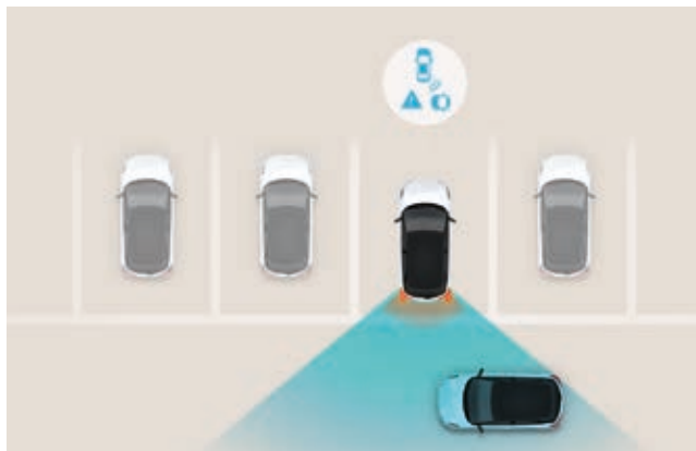
Alerta de aproximación de tráfico trasero activo (RCCA). Al dar marcha atrás en zonas de poca visibilidad, el sistema te avisa si se aproximan vehículos por el lateral y activa los frenos de forma automática.
