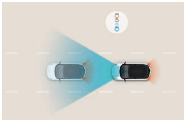
Sistema de asistencia a la frenada de emergencia (FCA). La carretera se monitoriza en todo momento gracias a un radar y una cámara en la parte frontal del vehículo; el sistema FCA te avisa y activa automáticamente el freno si detecta un frenazo repentino en el coche que circula delante o peatones o ciclistas cruzando la vía.
