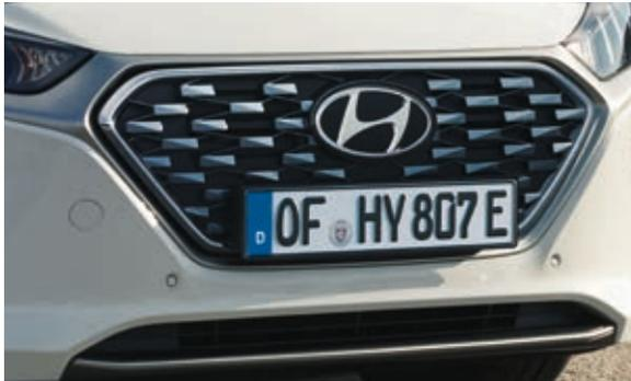
Todas las versiones disponen de una parrilla de aire activa controlada electrónicamente, para mejorar la aerodinámica según las condiciones de conducción.
