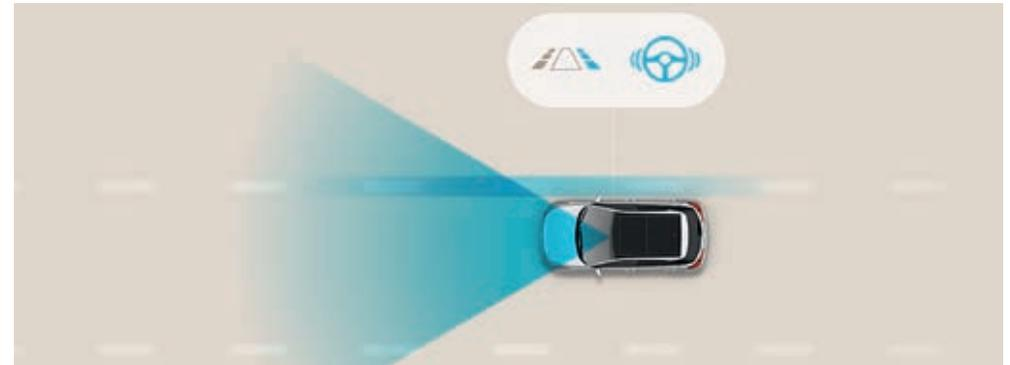
**Asistente de cambio involuntario de carril (LKA).** El sistema LKA dispone de unos sensores que detectan la posición del vehículo y avisa al conductor de cualquier maniobra peligrosa por encima de los 60km/h. Emite una señal acústica y visual antes de corregir automáticamente la dirección del vehículo para evitar la salida del carril.
