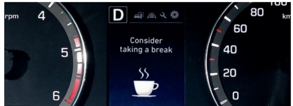
**Sistema de detección de fatiga del conductor (DAW).** Este dispositivo mejora los estándares de seguridad analizando y supervisando los patrones de conducción de forma constante. Cuando se detectan señales de fatiga o distracción el DAW emite una señal sonora para alertar al conductor y un mensaje en el panel de instrumentos sugiriendo realizar un descanso.
