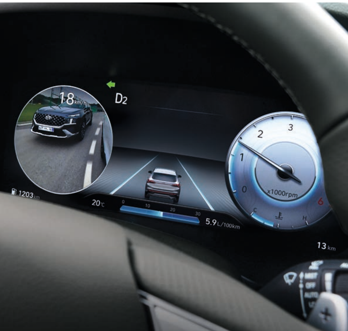
Panel de instrumentos digital de LCD de 12,3" y monitor de visualización de ángulos muertos
