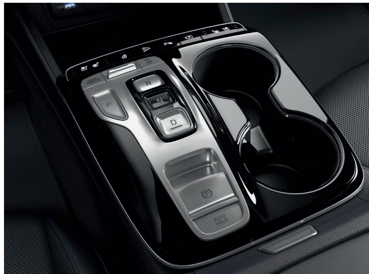
Tlačidlový prepínač režimov prevodovky shift-by-wire.
