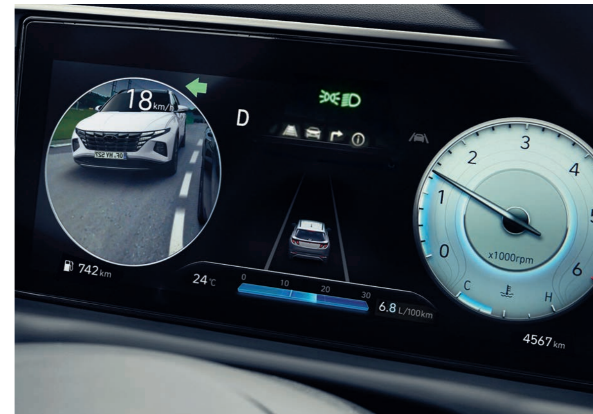
Monitorovanie mŕtveho uhla (BVM) Jazdný pruh môžete zmeniť bezpečne a pohodlne. Na displeji digitálneho združeného prístroja teraz môžete vidieť vľavo alebo vpravo dozadu. Kamery sa aktivujú pri použití smerových svetiel.
