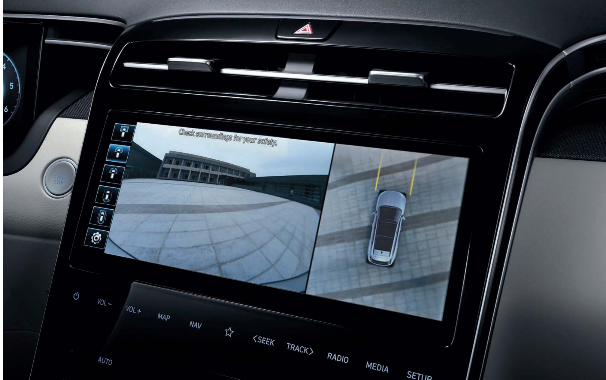
Systém monitorovania okolia vozidla (SVM) Výhľad v okruhu 360° pre pohodlnejšie a bezpečnejšie parkovanie. Štyri kamery s vysokým rozlíšením, namontované vpredu, vzadu a na bokoch, zobrazujú okolie vozidla v reálnom čase.
