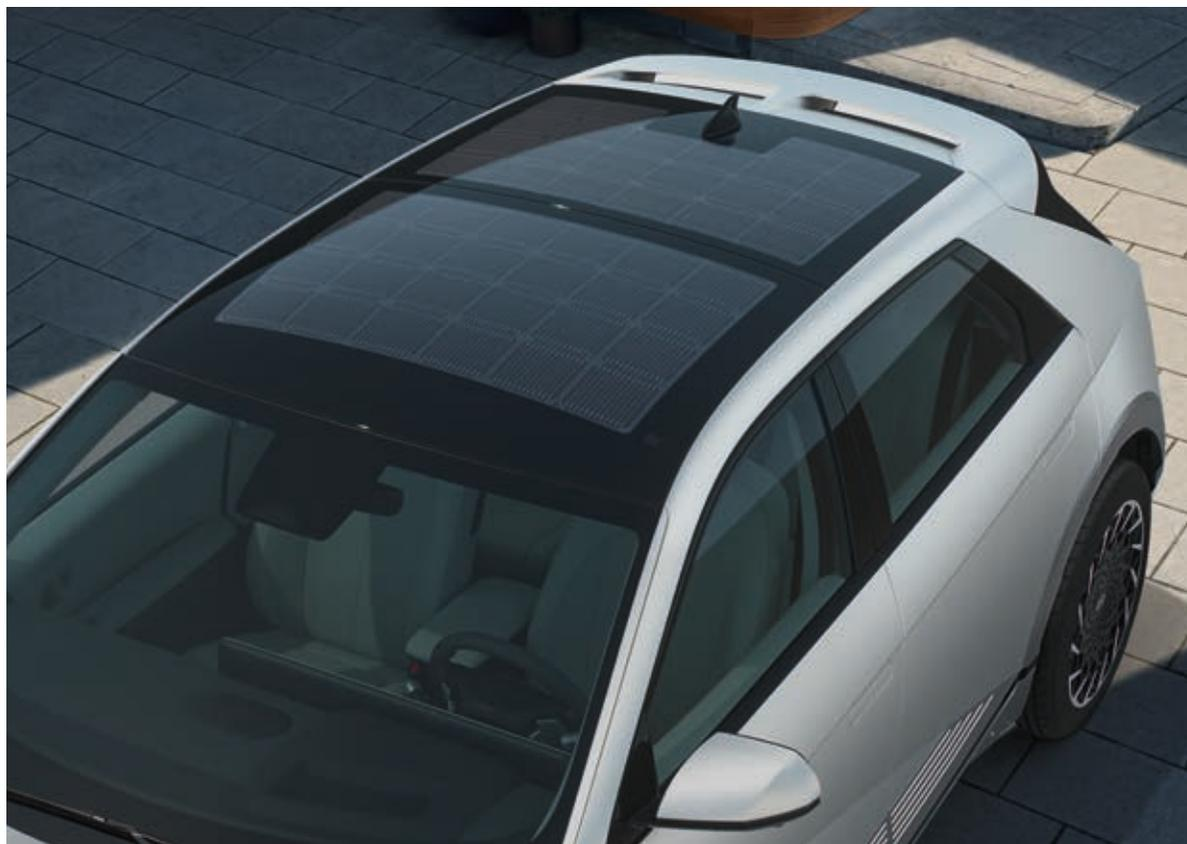
**Cargador solar en techo fotovoltaico.**
