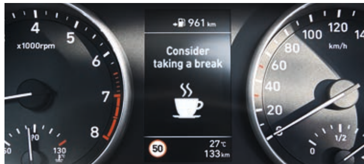
El sistema de detector de fatiga conductor (DAA) detecta la falta de atención del conductor y le avisa mediante alertas acústicas y visuales.
