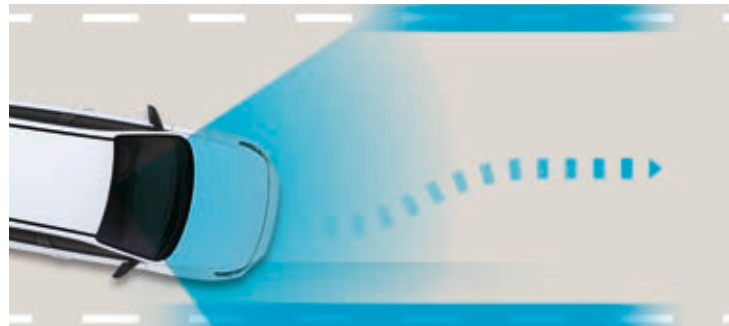
El sistema activo de cambio involuntario de carril (LKA) advierte al conductor en caso de salida de carril y corrige la trayectoria para mantener al vehículo dentro del carril, aumentando la seguridad.
