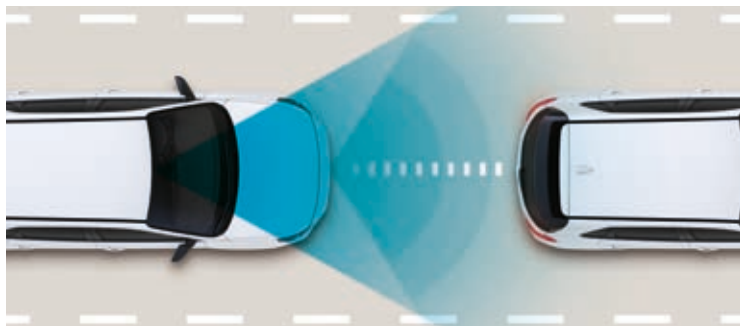
El sistema de asistencia a la frenada de emergencia (FCA), aplica la máxima potencia de frenada en caso de detectar una posible colisión.
