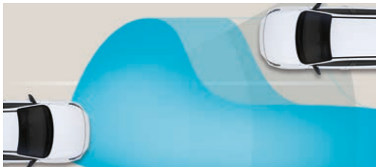
El sistema activo de luces de carretera (HBA) detecta los vehículos que se aproximan, así como los vehículos que circulan en el mismo carril por delante y cambia de luces de carretera a luces de cruce según corresponda.
