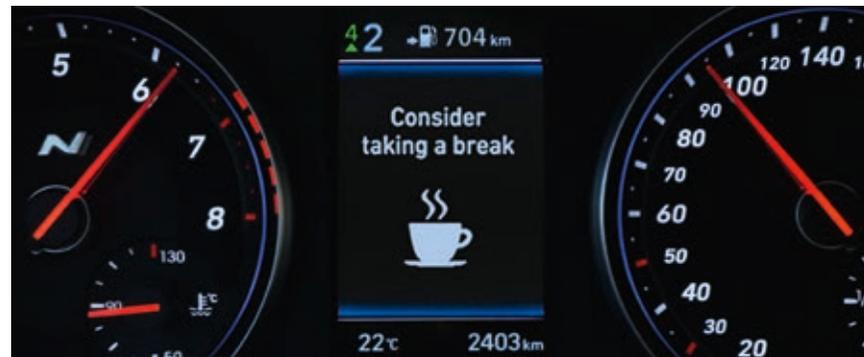
**Sistema de aviso de atención del conductor (DAW).** Esta función estándar aumenta la seguridad y la comodidad a un nivel completamente nuevo, al monitorizar y analizar continuamente los patrones de conducción. Una vez que identifica un patrón que muestra fatiga o distracción por parte del conductor, el DAW avisa al conductor con una alerta audible y un mensaje emergente, en el que le sugiere que se tome un descanso.
