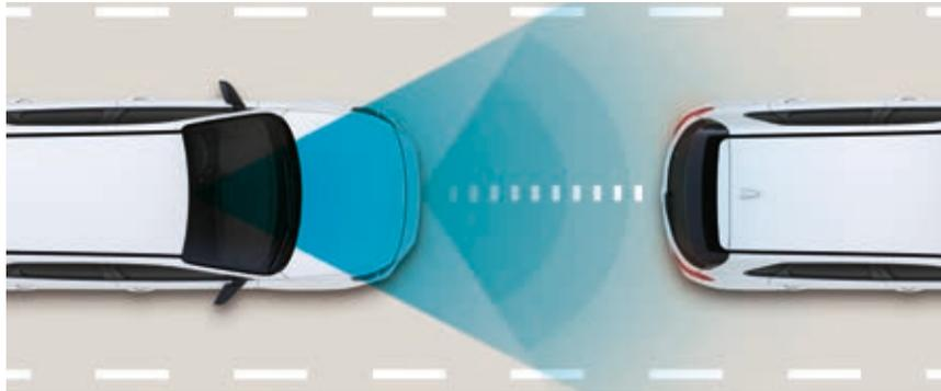
**Sistema de asistencia a la frenada de emergencia (FCA) con detección de vehículos.** Funciona en tres fases diferentes. Utiliza sensores de cámara y avisa al conductor de forma visual y audible en una primera fase. En la segunda fase, controla los frenos de acuerdo con la fase de peligro de colisión y, en una tercera fase, aplica la fuerza máxima de frenado para evitar la colisión o minimizar el daño si la colisión es inevitable.
