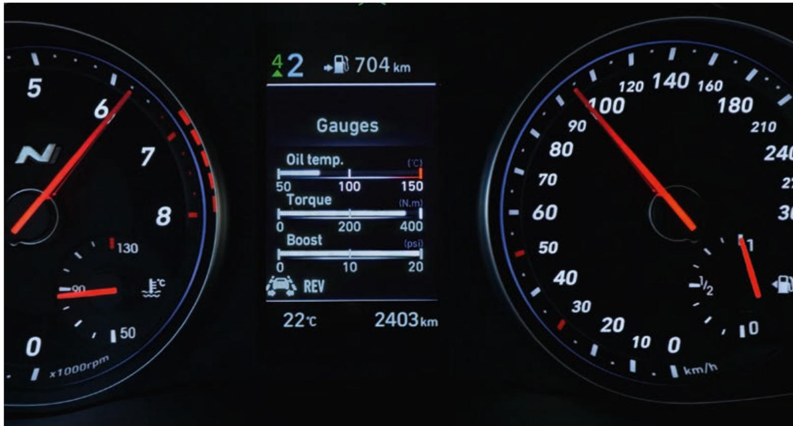
El ordenador de a bordo lo puedes personalizar a tu forma de conducción. Puedes controlar el par, el turbo boost y la temperatura del aceite del motor de un simple vistazo. El contador del cambio de marchas te será de gran ayuda en la conducción en pista y, la zona roja del cuentarevoluciones LED, cambia según el tipo de conducción
