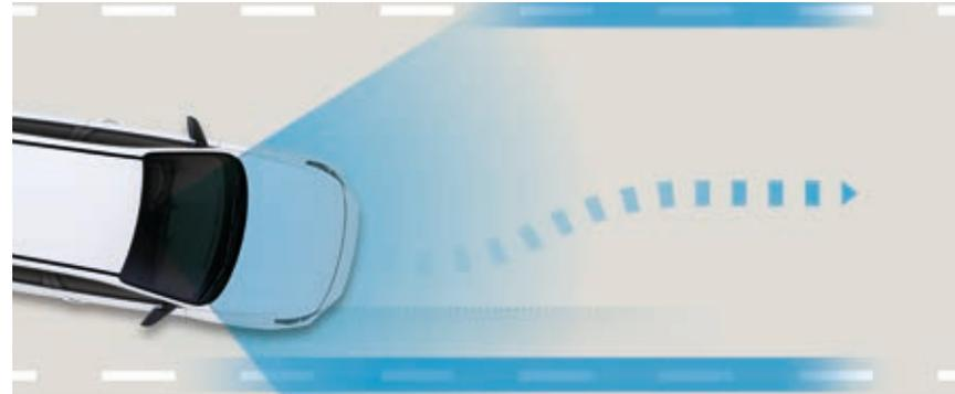
**Sistema activo de cambio involuntario de carril (LKA).** A velocidades superiores a 60 km/h, el sistema alerta al conductor sobre movimientos peligrosos. En caso de una salida involuntaria del carril, advertirá al conductor y aplicará un par de contra-volante con el que guiará el coche hacia una posición segura.
