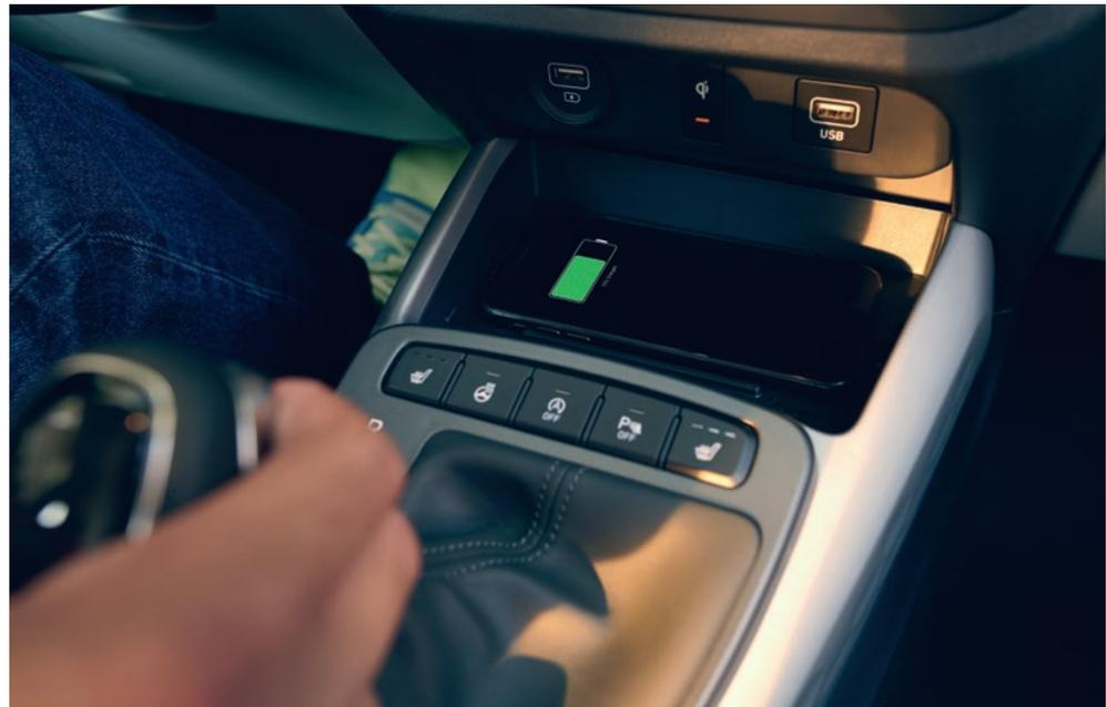
Caricate il vostro smartphone in tutta semplicità. Integrato nella console centrale, il dispositivo di ricarica wireless consente di ricaricare con la massima semplicità smartphone compatibili con la tecnologia Qi senza l'utilizzo di un cavo.
