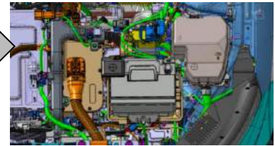
Batería en el vano motor
