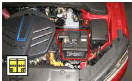
3. Cortar el conector de interbloqueo de servicio en el compartimento del motor.
