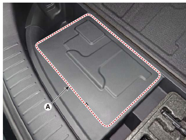
4-2 . Retire la cubierta de la batería de 12 V (A).
