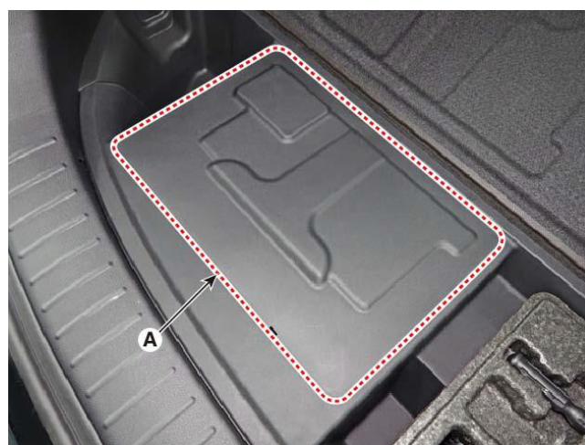
3-2 . Retire la cubierta de la batería de 12 V (A).
