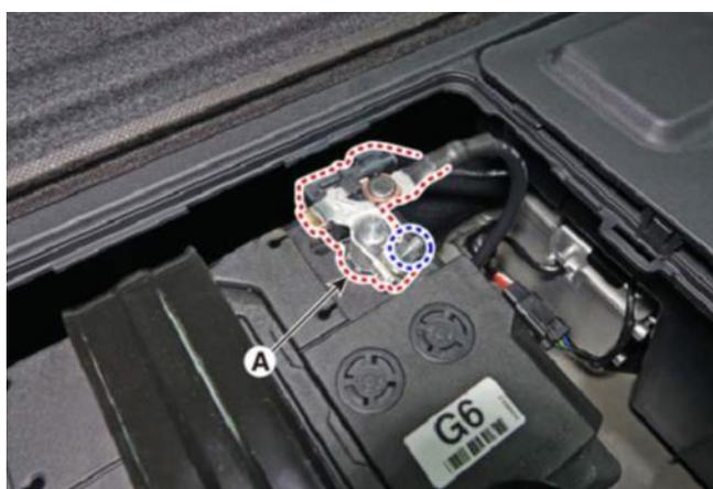
3-3 . Apague el botón de encendido y desconecte el polo negativo (-) de la batería auxiliar de 12 V (A).
