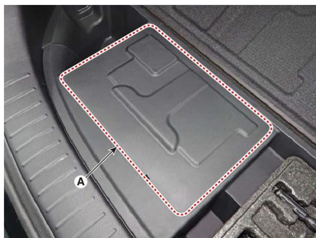
3-2 . Retire la cubierta de la batería de 12 V (A).
