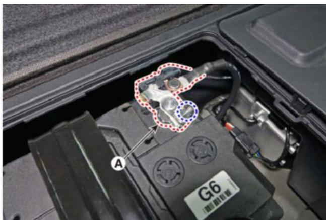
4-3 . Apague el botón de encendido y desconecte el polo negativo (-) de la batería auxiliar de 12 V (A).
