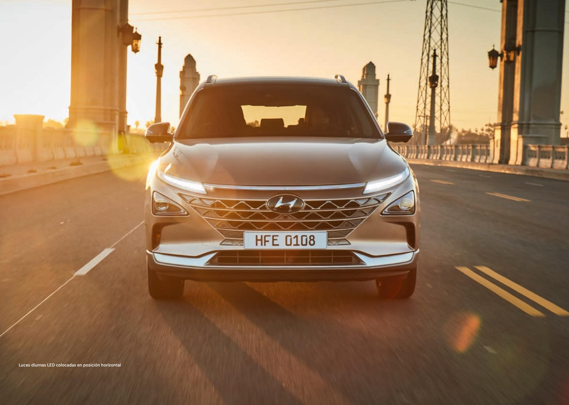
Luces diurnas LED colocadas en posición horizontal
