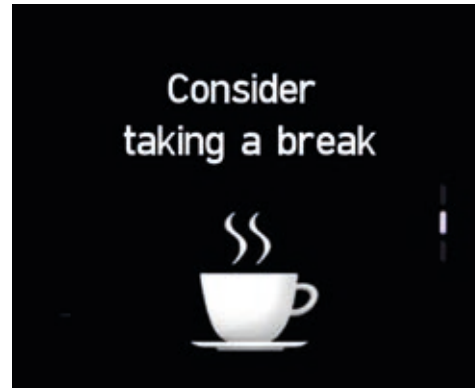
Sistema de atención al conductor (DAW). Cuando el sistema identifica cansancio o distracción, emite un aviso sonoro y un mensaje emergente para sugerirte que te tomes un descanso.
