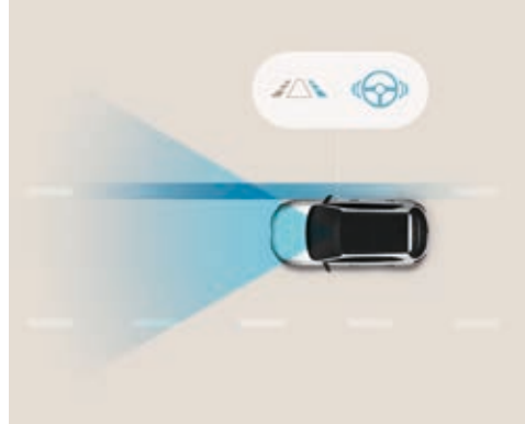
Sistema activo de cambio involuntario de carril (LKA). Este sistema utiliza la cámara frontal para monitorizar las líneas de la calzada. En caso de cambio involuntario de carril, el sistema avisa al conductor e interviene sobre la dirección para devolver el coche a su carril.
