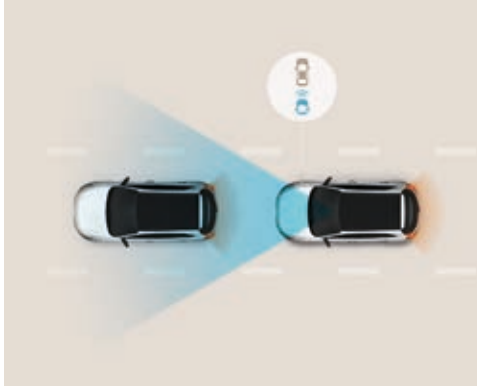
Sistema de asistencia a la frenada de emergencia (FCA). La carretera se monitoriza en todo momento gracias a un radar y una cámara en la parte frontal del vehículo; el sistema FCA te avisa y activa automáticamente el freno si detecta un frenazo repentino en el coche que circula delante. Este sistema detecta también a peatones y ciclistas.
