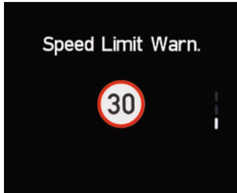
Alerta inteligente de limitación de velocidad (ISLW). Este sistema identifica las señales de la carretera y muestra los límites de velocidad y las prohibiciones de adelantamiento en tiempo real tanto en la pantalla del sistema de navegación como en el panel de instrumentos.
