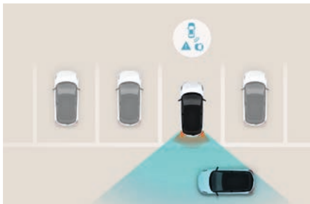
Alerta de aproximación de tráfico trasero activo (RCCA) Al dar marcha atrás en zonas de poca visibilidad, el sistema avisa al conductor si se aproximan vehículos por el lateral y activa los frenos de forma automática en caso de detectar una posible colisión.
