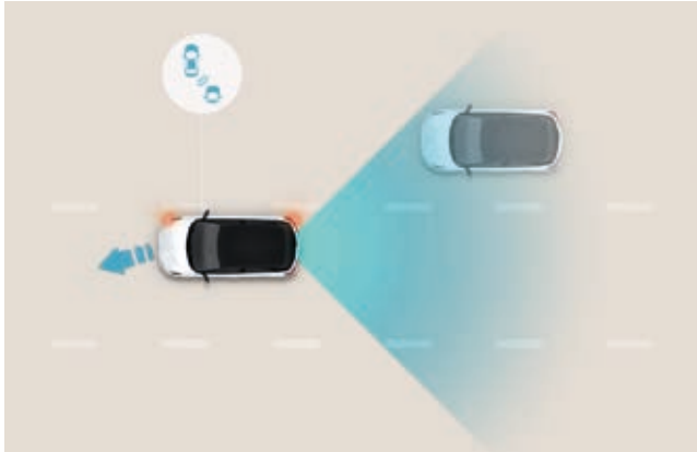
Sistema de detección de ángulo muerto (BCA). Mediante dos sensores situados en la parte inferior del paragolpes trasero, el sistema te avisa de los vehículos que se acercan por la zona del ángulo muerto. Si activas el intermitente en esa dirección, el sistema emite una señal acústica y activa el freno para evitar la colisión en caso necesario.
