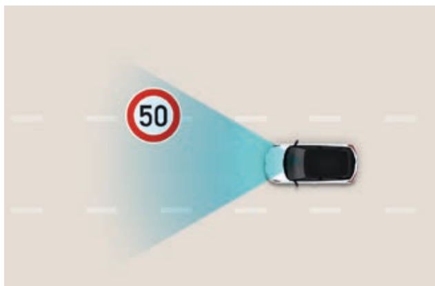
Asistente inteligente de límite de velocidad (ISLA) Este sistema emite alertas acústicas y visuales si circulas por encima de la velocidad permitida en la vía. Cuando se combina con el limitador manual de velocidad o el control de crucero inteligente, ISLA puede incluso ajustar la velocidad de forma autónoma.
