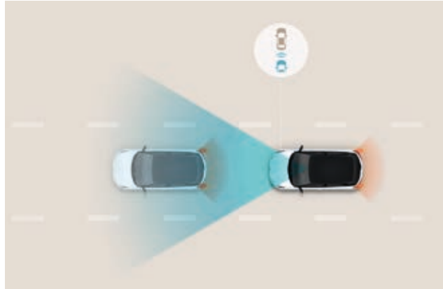
Sistema de asistencia a la frenada de emergencia (FCA). La carretera se monitoriza en todo momento gracias a un radar y una cámara en la parte frontal del vehículo; el sistema FCA te avisa y activa automáticamente el freno si detecta una posible colisión repentina en el coche que circula delante. Este sistema detecta también a peatones e incluso puede detectar también a ciclistas.
