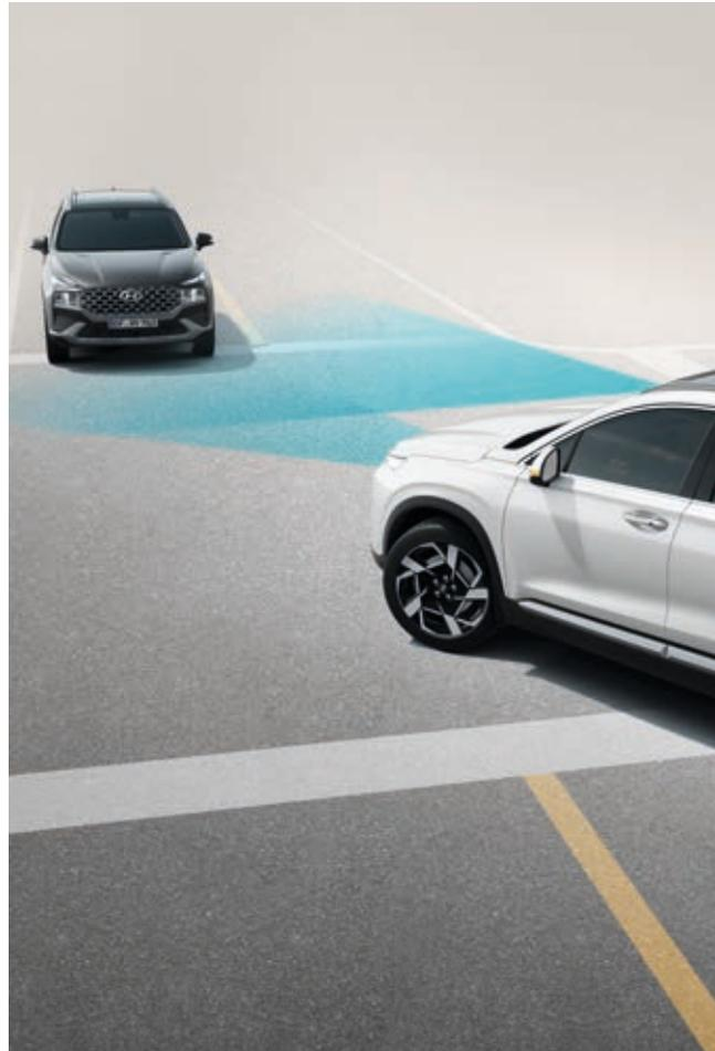
**Sistema para evitar colisiones frontales (FCA, giro en intersecciones).**
