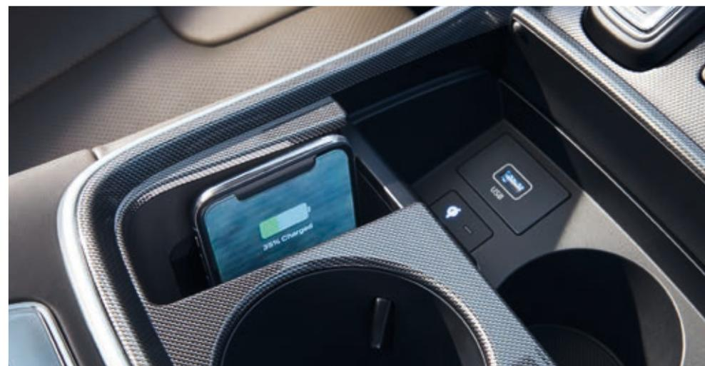
Sistema inalámbrico de carga del smartphone
