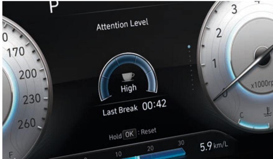
Detector de atención del conductor
