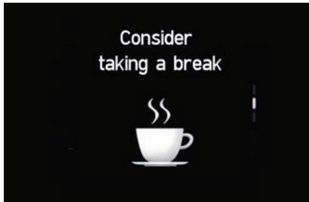
**Sistema de detección de fatiga del conductor (DAA).**
