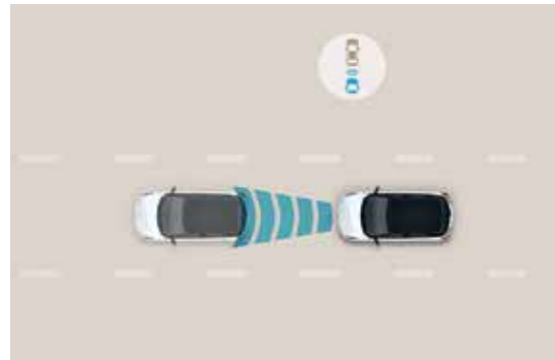
Smart Cruise Control (SCC w/Stop & Go) Meer veiligheid en minder stress. Dit systeem houdt een vaste afstand tot de voorligger en laat de wagen automatisch versnellen of vertragen volgens een vooraf ingestelde snelheidslimiet. Ook in 'stop & go' verkeer wordt een vooraf bepaalde afstand behouden.
