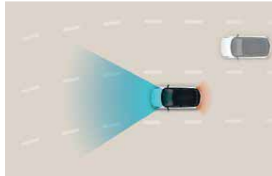
Navigation-based Smart Cruise Control Curve (NSCC-C) Via het state-of-the-art navigatiesysteem anticipeert het systeem op zowel bochten als rechte stukken die eraan komen, en past de snelheid automatisch aan voor een veiliger rijervaring.
