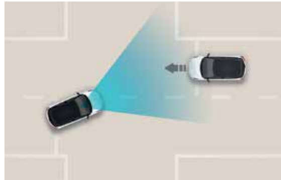
Forward Collision-Avoidance Assist (FCA with junction turning function) Het FCA-systeem houdt de weg voor de auto met een radar en een camera in het oog en bedient automatisch de remmen wanneer de voorligger plots vertraagt, of er zich er voetgangers of fietsers op de weg bevinden. Het systeem wordt ook geactiveerd als er aanrijdingsgevaar wordt gedetecteerd als je links afdraait op een kruispunt.
