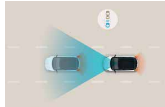
Forward Collision-Avoidance Assist (FCA) Het standaard FCA-systeem waarschuwt en remt automatisch wanneer de camera een voorligger opmerkt die plots vertraagt, of wanneer er zich er voetgangers of fietsers op de weg bevinden.
