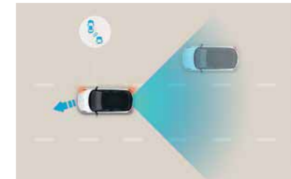
Blind Spot Collision-Avoidance Assist (BCA) Door middel van 2 radarsensoren in het onderste deel van de achterbumper waarschuwt dit systeem je voor verkeer in je dode hoek. Als je in een dergelijke situatie de richtingaanwijzer inschakelt, weerklinkt er een geluidssignaal en remt het systeem af om een aanrijding te vermijden.
