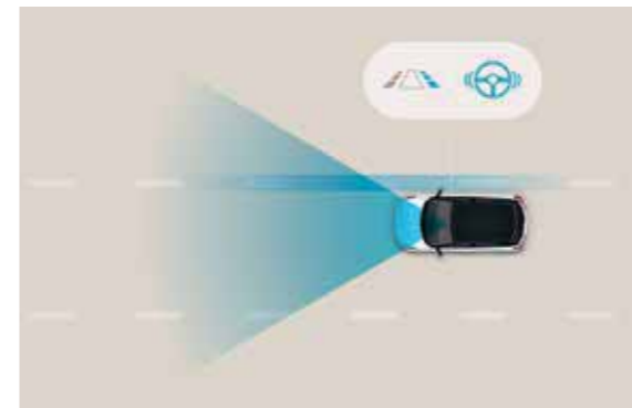
Lane Keeping Assist (LKA) Het systeem waarschuwt de bestuurder als de wagen onbedoeld van zijn rijstrook afwijkt en kan automatisch bijsturen om de wagen binnen zijn rijstrook te houden.
