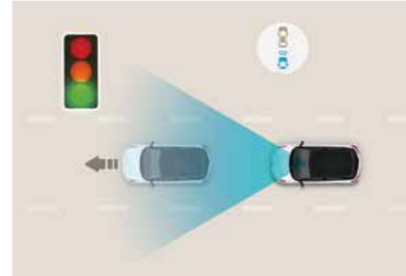
Leading Vehicle Departure Alert (LVDA) Waarschuwt de bestuurder als een voorligger wegrijdt en de bestuurder niet tijdig reageert, bijvoorbeeld in files of voor een verkeerslicht.
