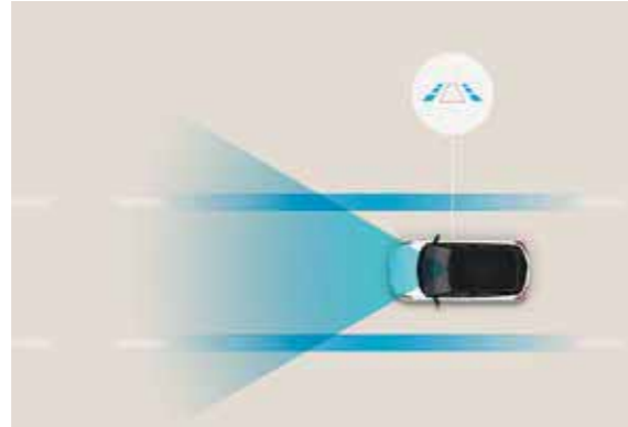
Lane Following Assist (LFA) Dit systeem houdt de wagen in het midden van de rijstrook bij snelheden van 0 tot 185 km/u op snelwegen en in stadsverkeer.
