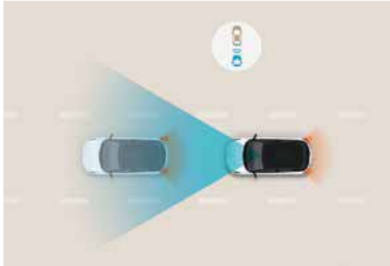
Forward Collision-avoidance Assist (FCA) Het standaard FCA-systeem waarschuwt en remt automatisch wanneer de camera een voorligger opmerkt die plots vertraagt, of wanneer er zich er voetgangers of fietsers op de weg bevinden.
