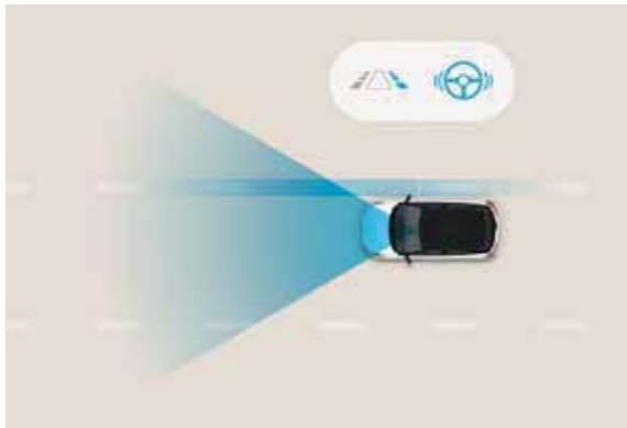
Lane Keeping Assist (LKA) Het systeem waarschuwt de bestuurder als de wagen onbedoeld van zijn rijstrook afwijkt en kan automatisch bijsturen om de wagen binnen zijn rijstrook te houden.
