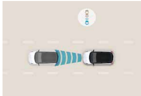
Smart Cruise Control (SCC w/Stop & Go) Meer veiligheid en minder stress. Dit systeem houdt een vaste afstand tot de voorligger en laat de wagen automatisch versnellen of vertragen volgens een vooraf ingestelde snelheidslimiet. Ook in 'stop & go' verkeer wordt een vooraf bepaalde afstand behouden.
