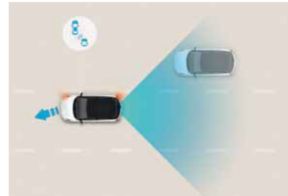
Blind Spot Collision-avoidance Assist (BCA) Door middel van 2 radarsensoren in het onderste deel van de achterbumper waarschuwt dit systeem je voor verkeer in je dode hoek. Als je in een dergelijke situatie de richtingaanwijzer inschakelt, weerklinkt er een geluidssignaal en remt het systeem af om een aanrijding te vermijden.
