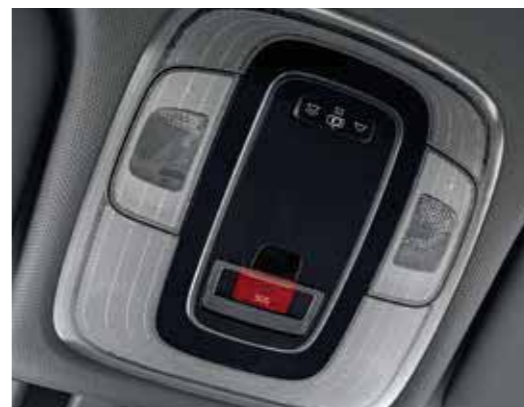
Bouton E-call Cette fonction appelle automatiquement les services d'urgence si vous avez un accident et que les airbags se déploient. Vous pouvez également appuyer sur le bouton SOS pour une assistance d'urgence, 24h/24, 7j/7 et 365 jours par an.
