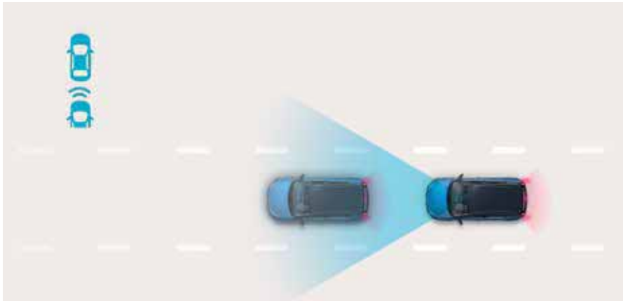
Le système Forward Collision-avoidance Assist freine automatiquement lorsqu’il détecte que la voiture qui précède freine brusquement ou qu’il détecte des piétons ou des cyclistes sur la route.
