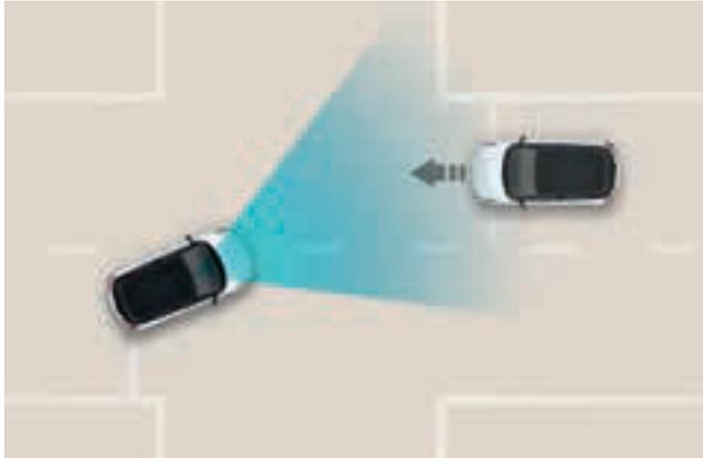
**Autonomer Notbremsassistent (mit Kreuzungsassistent).**
