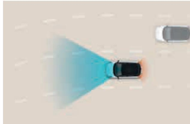
**Navigationbasierter adaptiver Tempomat mit Distanz- und Kurvenassistent.**
