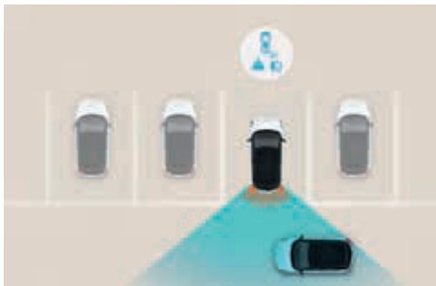
**Querverkehrswarner hinten mit Bremsassistent.**
