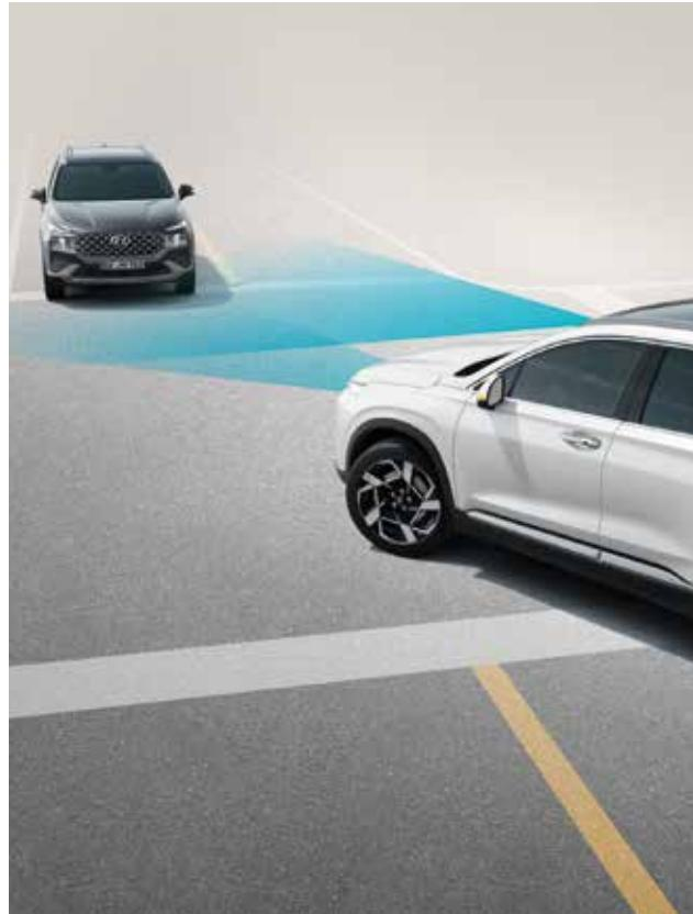
**Automatisk nødbremssistent med veikryssassistent for sving til venstre**
