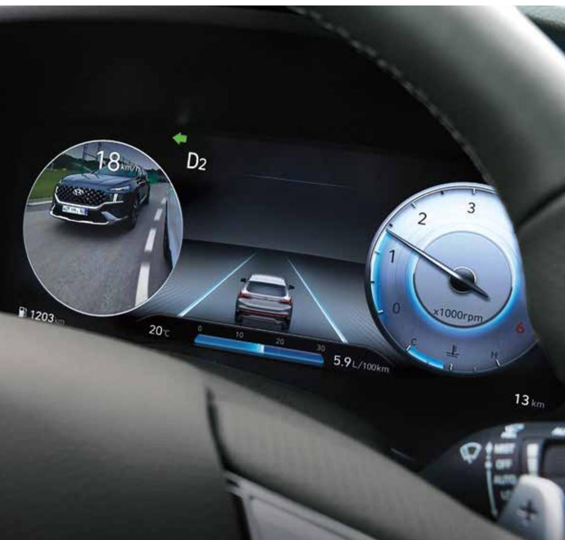
12,3-tommers LCD-instrumentdisplay med visning fra blindsoneovervåkningen.
