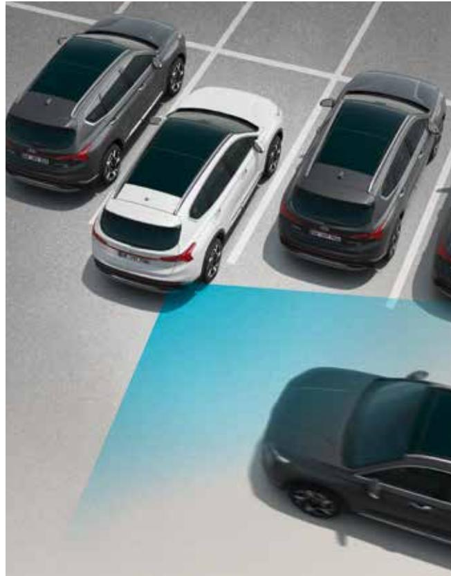
**Nødbremssistent med varsling om kryssende trafikk bak**
