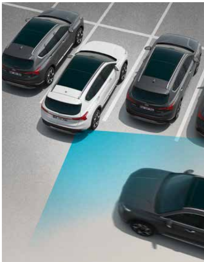
Nødbremsassistent med varsling om kryssende trafikk bak Når du rygger i områder med dårlig sikt, vil systemet varsle deg dersom kjøretøy nærmer seg fra siden. I tillegg vil det automatisk bremse bilen.
