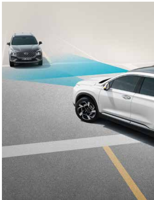
Automatisk nødbremsassistent med veikryssassistent for sving til venstre Systemet varsler deg og bremses automatisk hvis det oppdager at kjøretøyet foran bråbremser, eller det er fotgjengere eller syklister i veien. Det samme gjelder ved fare for kollisjon med møtende kjøretøyer når du svinger til venstre i veikryss.
