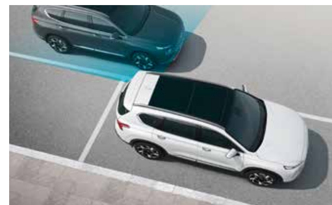
Blindsoneassistent Systemet bruker radarene i den nedre støtfangeren bak og frontkameraet og varsler deg om kjøretøyer i blindsonen. Hvis du setter på blinklyset i en slik situasjon, vil systemet varsle deg med et lydsignal og bremse for å forhindre en kollisjon.
