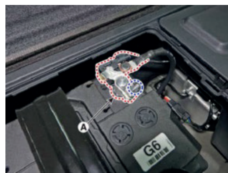
4-3. Wyłączyć stacyjkę (stan OFF) i odłączyć zacisk ujemny (-) (A) akumulatora 12 V.
