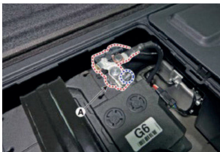
4-2. Wyłączyć stacyjkę (stan OFF) i odłączyć zacisk ujemny (-) (A) akumulatora 12 V.
