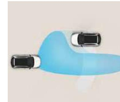
**Forward Collision-avoidance Assist (FCA).** Grazie alla telecamera e al radar, che permettono il rilevamento del tratto di strada davanti alla propria vettura, il sistema FCA ti avvisa prima di frenare automaticamente in caso di frenata improvvisa dell'auto che precede. Il sistema rileva anche pedoni e ciclisti.
